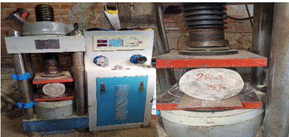
Fotografía 18. Ensayo de resistencia a tracción.
