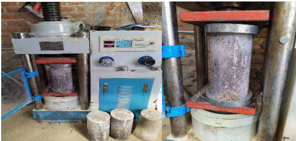
Fotografía 17. Ensayo de resistencia a compresión.
