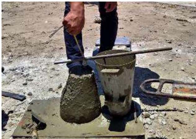
Fotografía 12. Asentamiento del concreto fresco.
