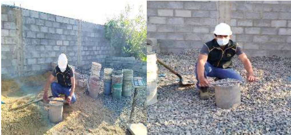
Fotografía 8. Ensayo de peso unitario del agregado fino y grueso.
