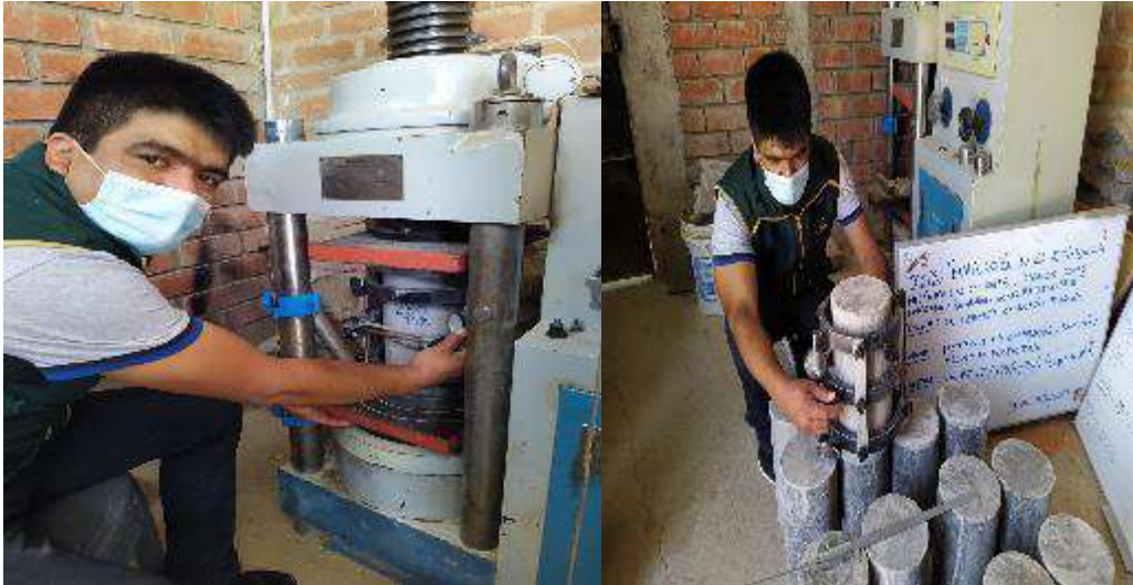
Fotografía 20. Ensayo de Modulo de elasticidad.
