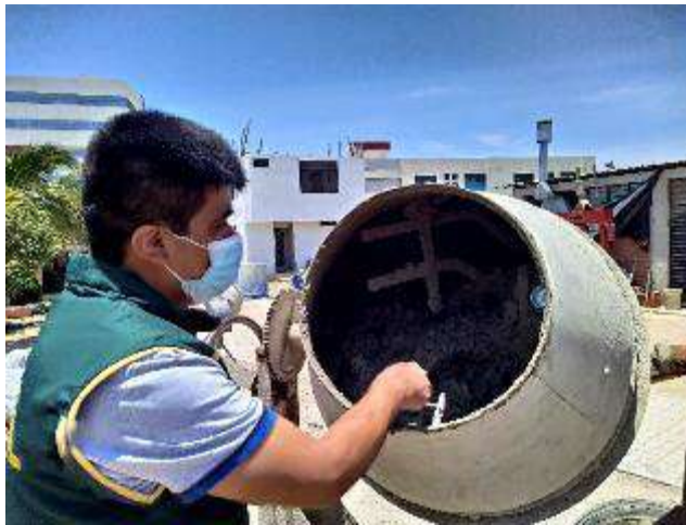
Fotografía 11. Preparación de concreto normal y experimental.
