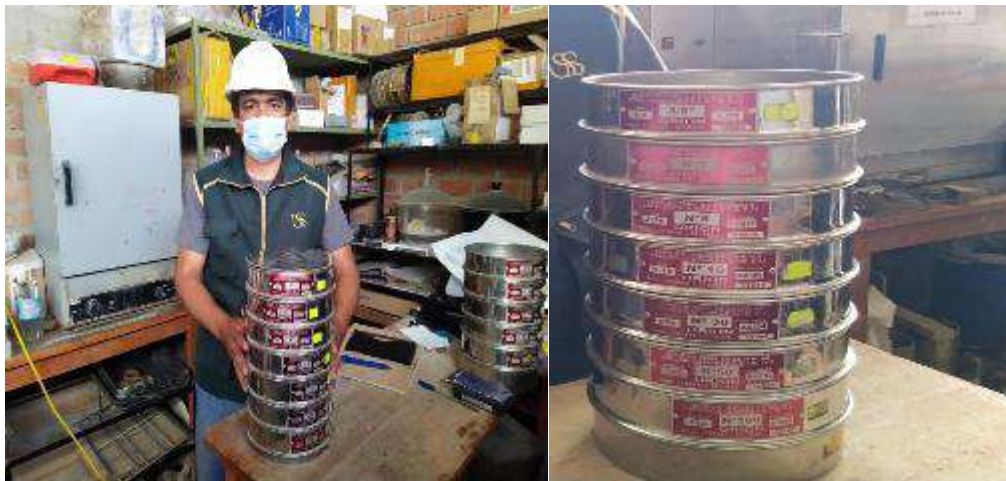
Fotografía 7. Análisis granulométricos agregados naturales y agregado reciclado.
