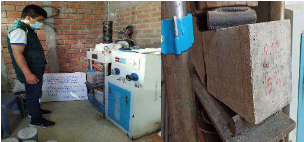
Fotografía 19. Ensayo de resistencia a flexión.
