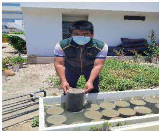
Fotografía 15. Curado de especímenes cilíndricos y prismáticos.
