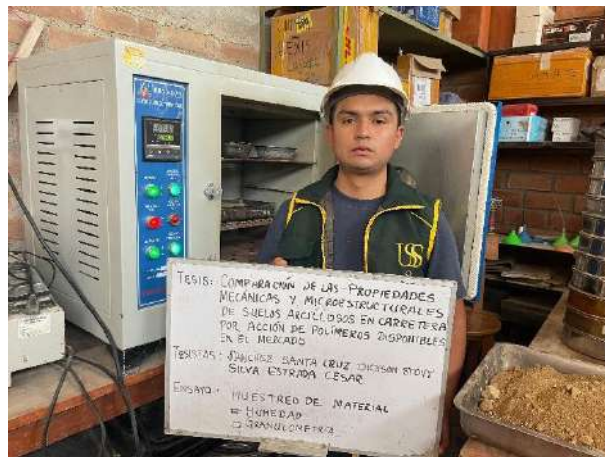
Humedad natural de la muestra.
