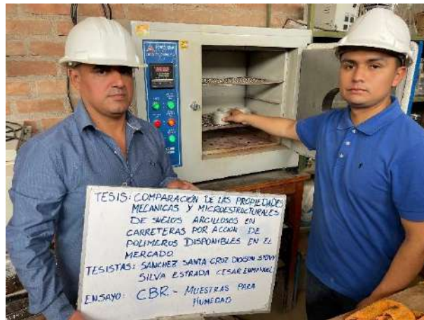
Muestras para humedad (CBR)
