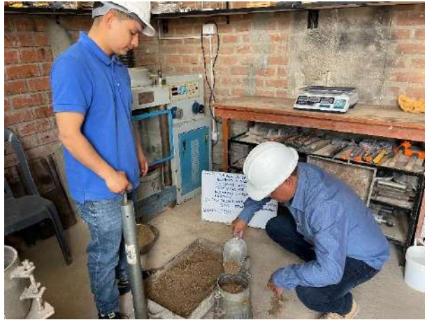
Preparación de muestra para ensayo CBR
