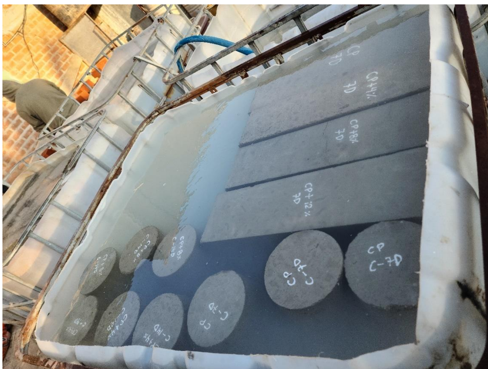
Ilustración 14. Curado de muestras para un tiempo de 7-14 y 28 días
