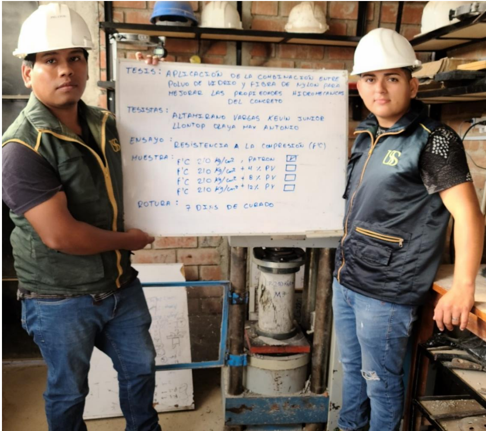
Ilustración 15. Resistencia a compresión del concreto
