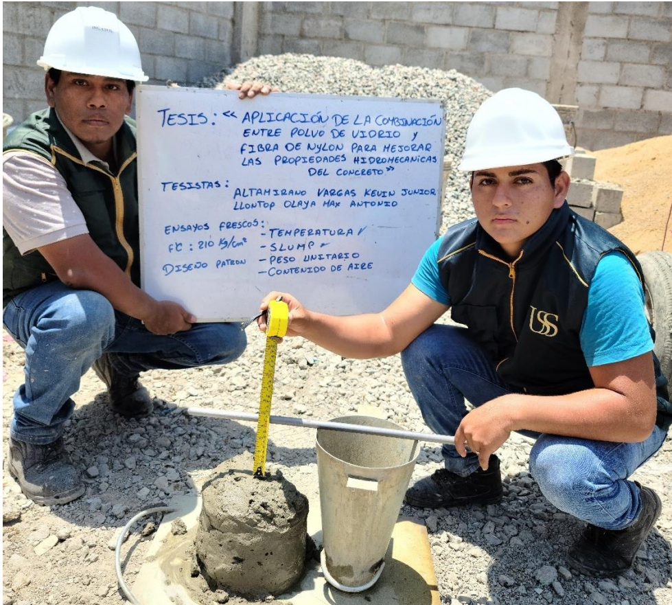
Ilustración 9. Ensayo de Slump f'c = 210 \text{ kg/cm}^2
