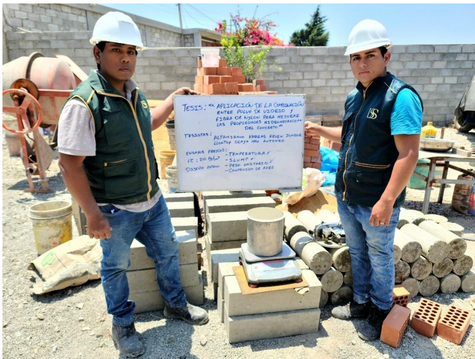
Ilustración 10. Ensayo de Peso Unitario f'c = 210 \text{ kg/cm}^2
