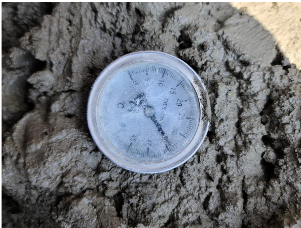
Ilustración 12. Ensayo de Temperatura f'c = 210 kg/cm 2
