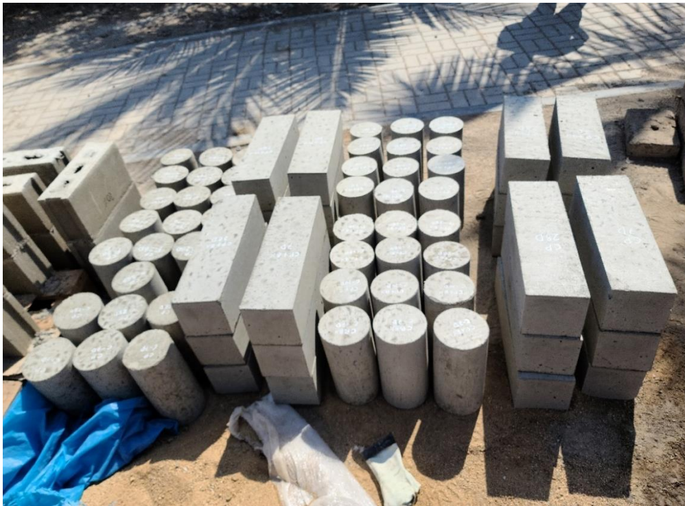
Ilustración 13. Muestras de concreto para ensayos hidromecánicos
