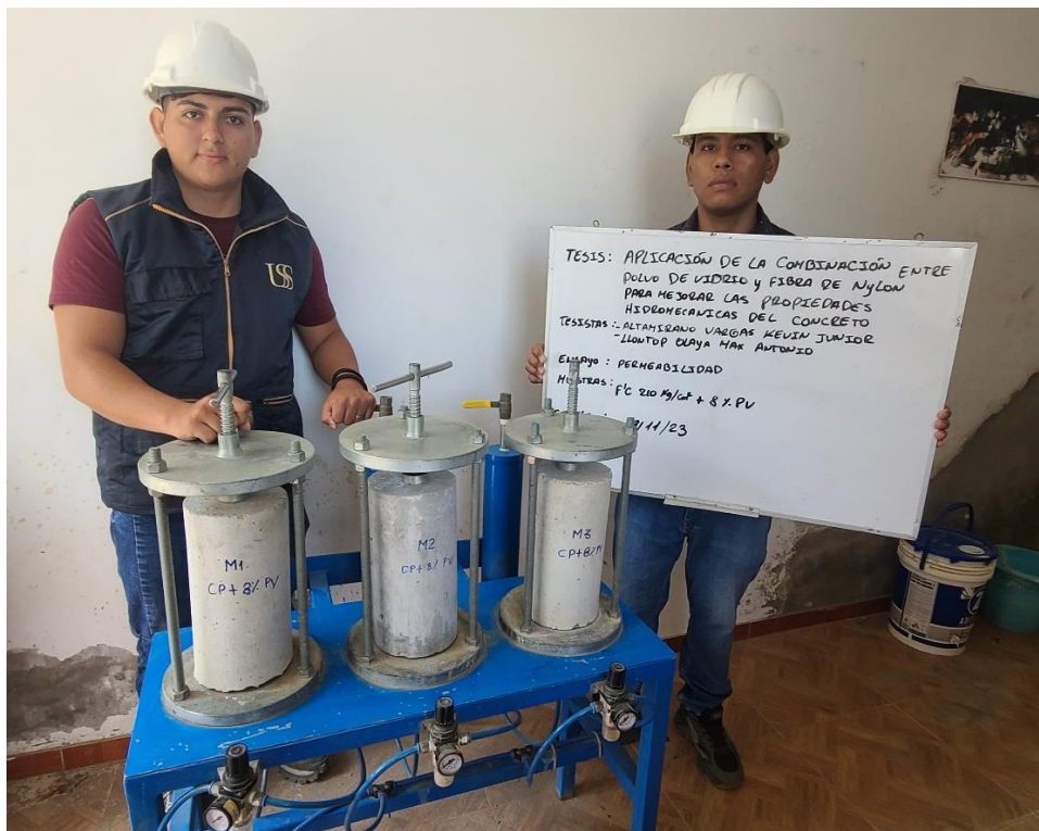
Ilustración 18. Ensayo de permeabilidad del concreto
