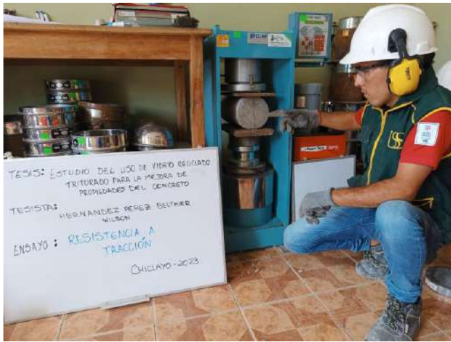
Ensayo de resistencia a la tracción
