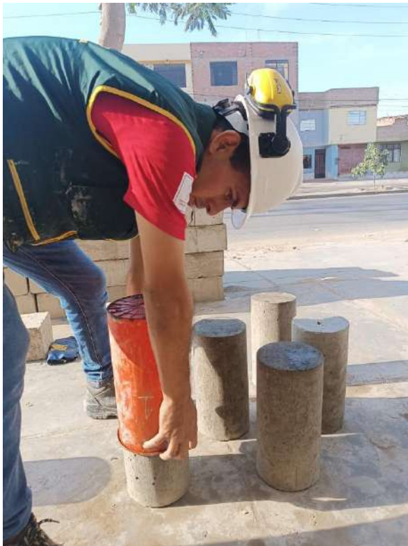
Desencofrado de probetas
