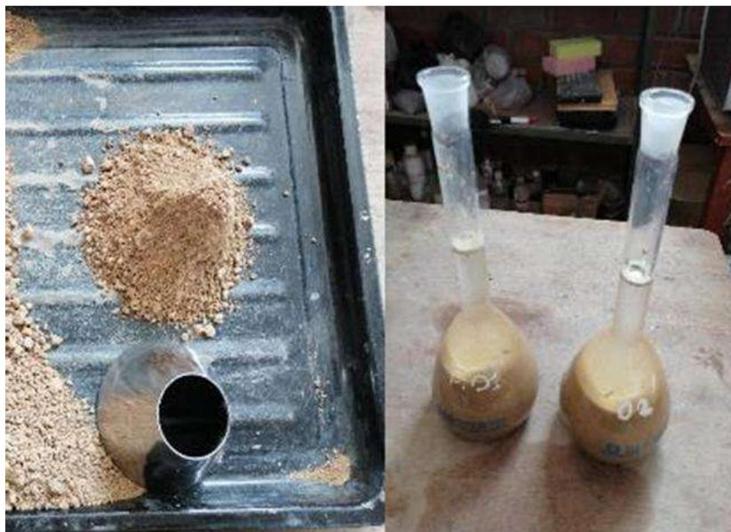
FOTO- ENSAYO DE PESO ESPECIFICO Y ABSORCION DEL AGREGADO GRUESO
