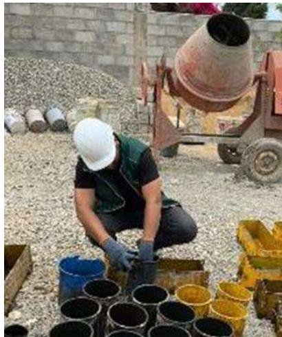
FOTO-ENSAYO DE ASENTAMIENTO PARA CT Y CT+FS
