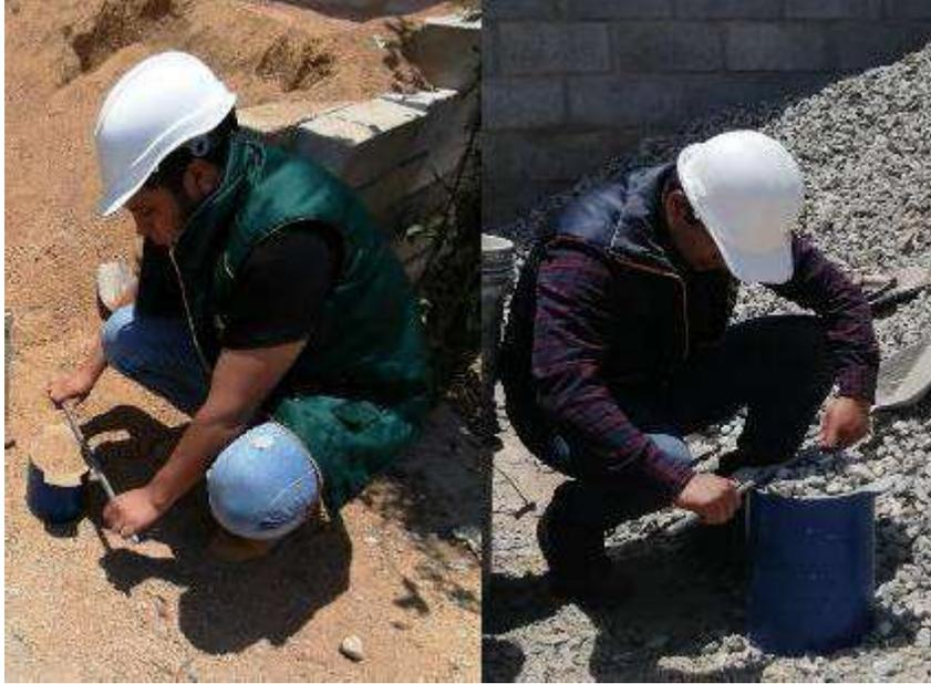
FOTO – ENSAYO DE PESO UNITARIO COMPACTADO DEL AGREGADO FINO Y GRUESO
