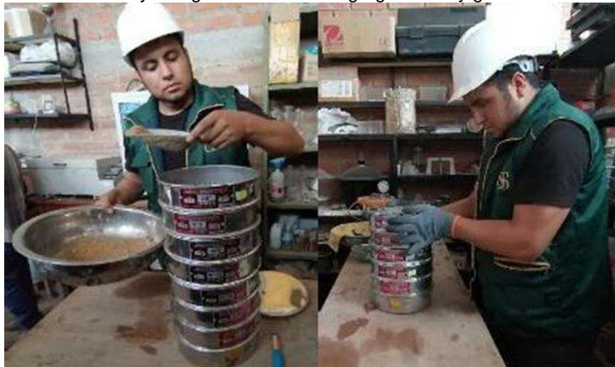
FOTO- ENSAYO DE PESO UNITARIO DUELTO DEL AGREGADO FINO Y GRUESO
