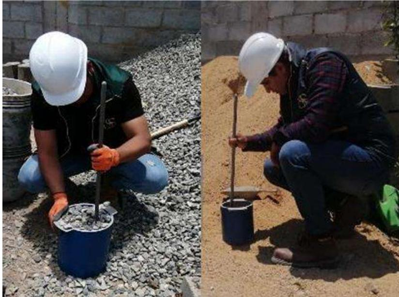
FOTO- ENSAYO DE PESO ESPECIFICO Y ABSORCION DEL AGREGADO FINO
