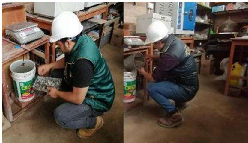
FOTO- ENSAYO DE CONTENID DE HUMEDAD DEL AGREGADO FINO Y GRUESO
