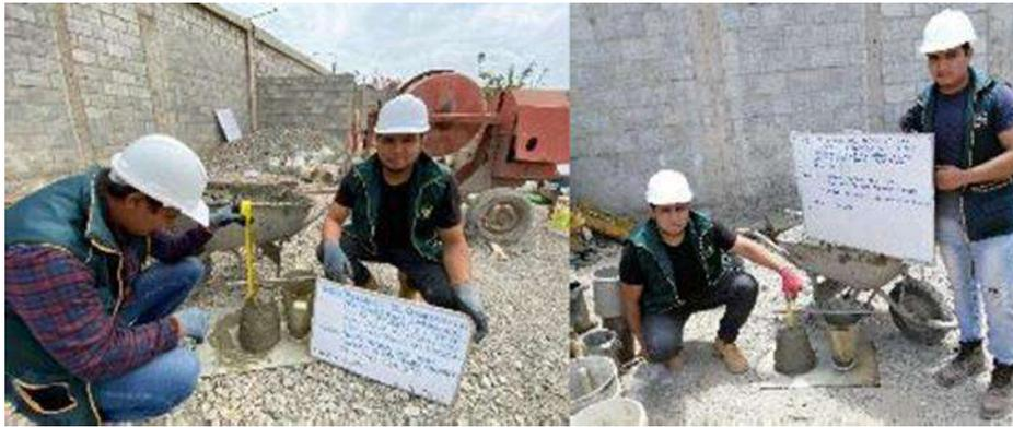
FOTO- ENSAYO DE PESO UNITARIO PARA CT Y CT+FS
