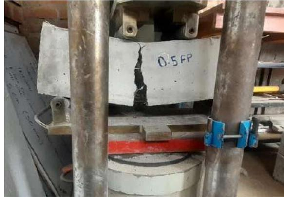
Fig.19. Especímen con FPm luego de la falla por flexión.
