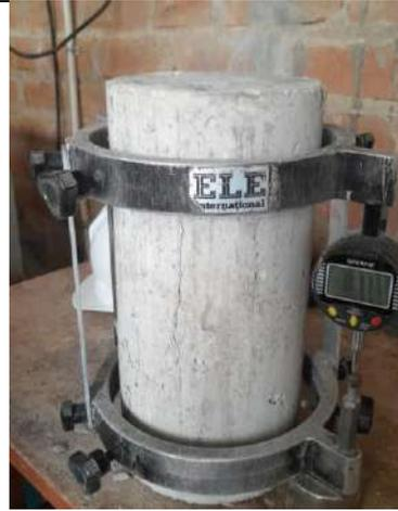
Fig.14. Ensayo de resistencia a compresión.
