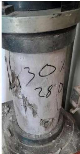
Fig.21. Modos de falla en especímenes luego de ensayo a compresión.
