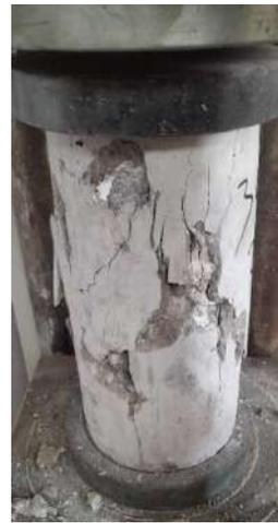
Fig.22. Modos de falla en especímenes luego de ensayo a compresión.
