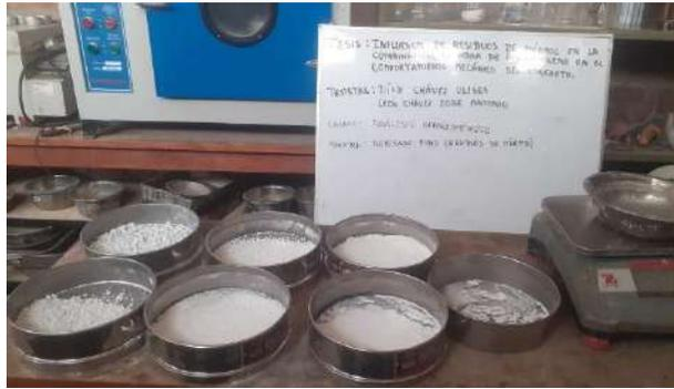
Fig.2. Análisis granulométrico de los RM
