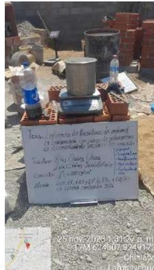
Fig.11. Ensayo de peso unitario a la mezcla de concreto
