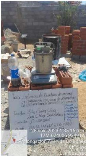
Fig. 10. Ensayo de contenido de aire a la mezcla de concreto.
