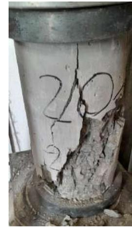
Fig.20. Modos de falla en especímenes luego de ensayo a compresión.
