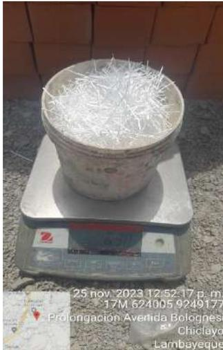
Fig. 4, Fibra para ser agregada a la mezcla
