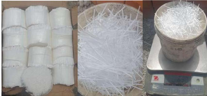
**Fig 4.** Fibras macro sintéticas de polipropileno.
