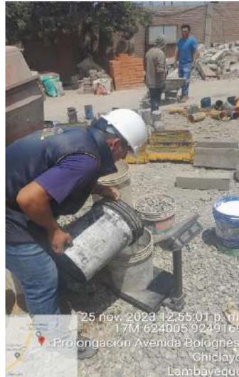
Fig.5. Control de cantidad de materiales por tanda de ensayo
