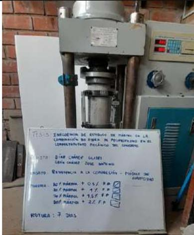
Fig.13. Ensayo de resistencia a compresión.
