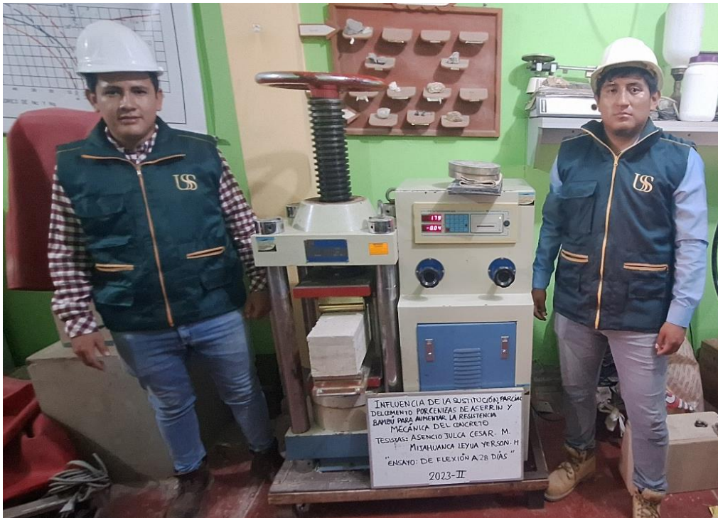
Fotografía 12. Resistencia a la Flexión en muestras de concreto
