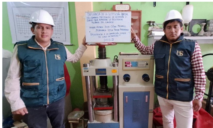
Fotografía 08. Ensayo a compresión simple de cubos de mortero
