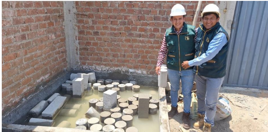
Fotografía 07. Curado de probetas
