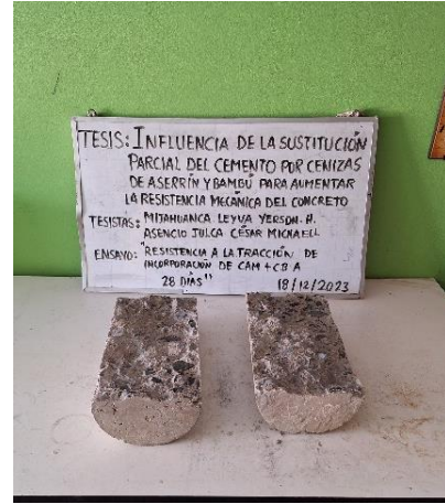
Fotografía 10 y 11. Resistencia a la Tracción en muestras de concreto
