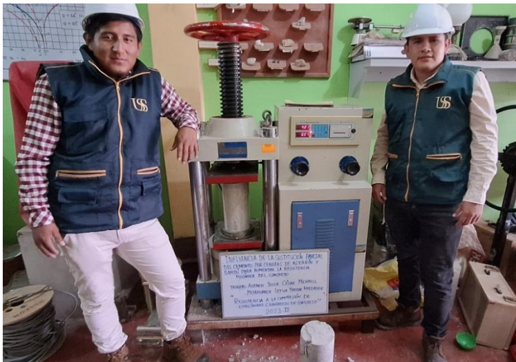
Fotografía 09. Ensayo a compresión de los especímenes de concreto
