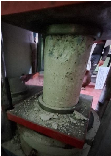
Fotografía 09. Ensayo a compresión de los especímenes de concreto
