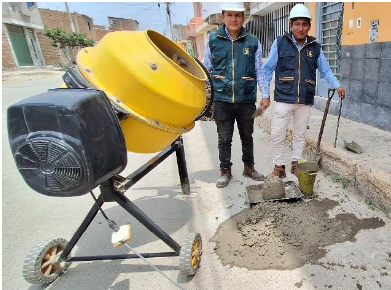
Fotografía 03. Ensayo de concreto en estado fresco (slump)
