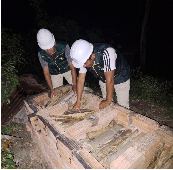
Fotografía 01 y 02. Armado de horno y calcinación de aserrín de madera y bambú.
