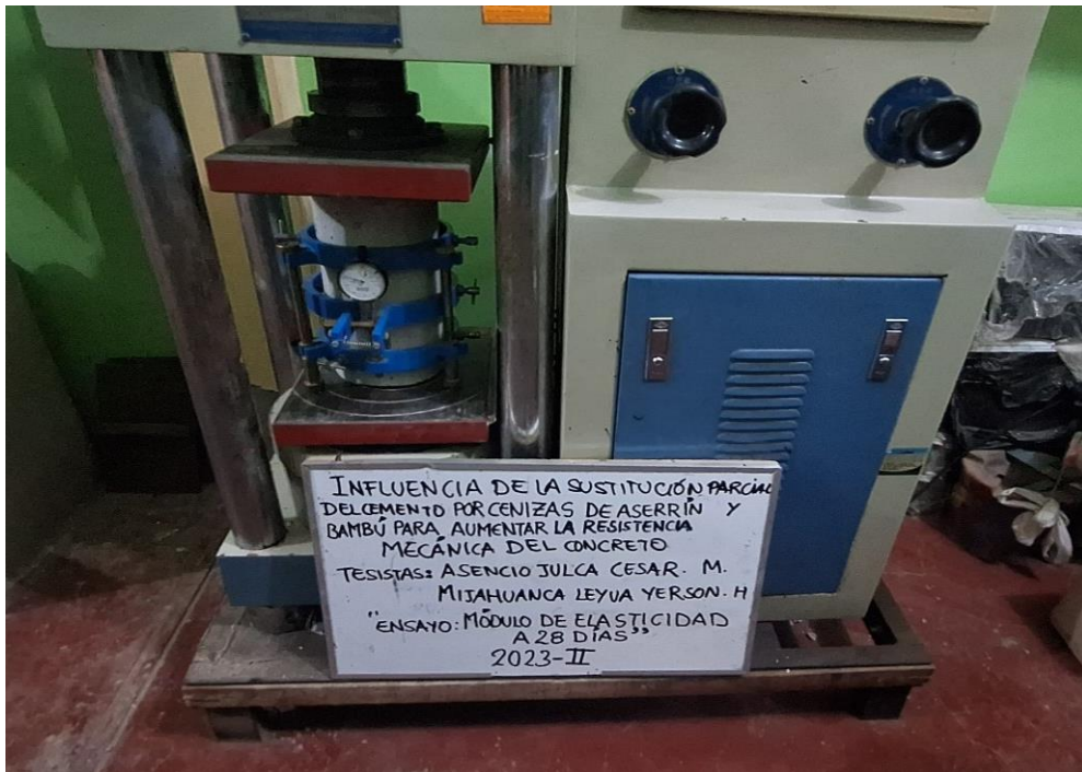
Fotografía 13. Módulo de Elasticidad de las muestras de concreto
