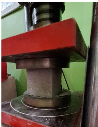
Fotografía 08. Ensayo a compresión simple de cubos de mortero
