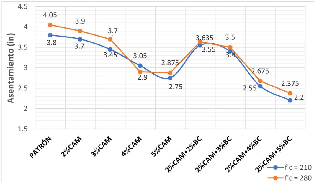
**Fig. 3** Resultados de ensayo de slump
