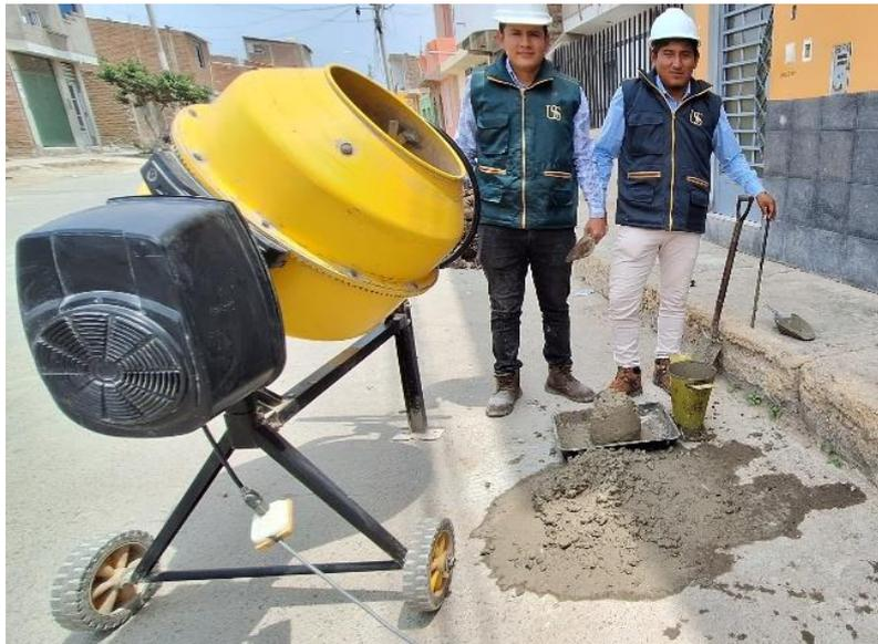
**Fotografía 03. Ensayo de concreto en estado fresco (slump)**
