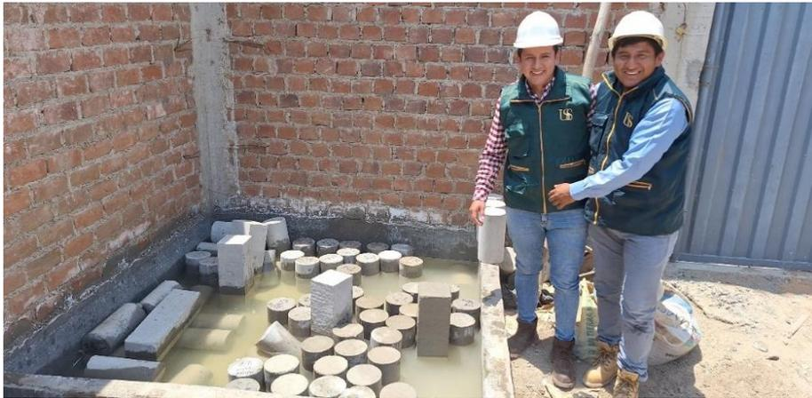
**Fotografía 07.** Curado de probetas
