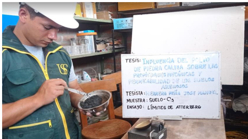
Foto: Ensayos de limites de Atterberg
