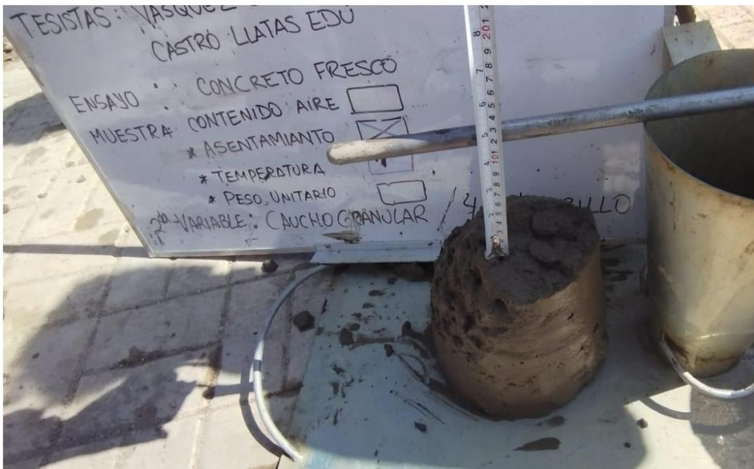
**Ilustración 12. Slump del concreto**
