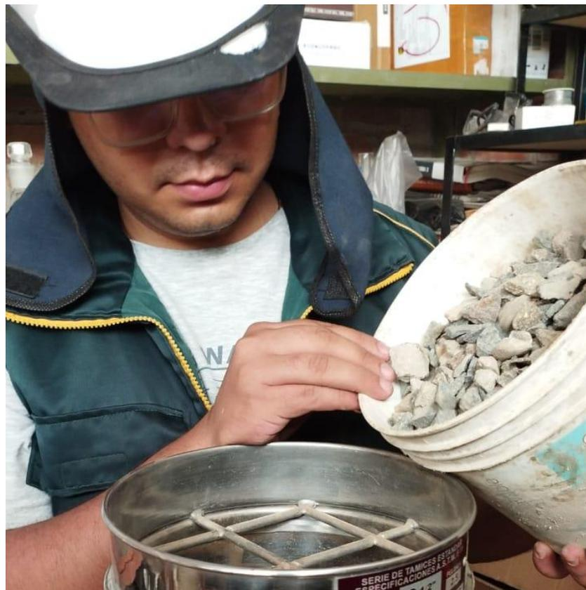
***Ilustración 6. Granulometría del agregado grueso***
