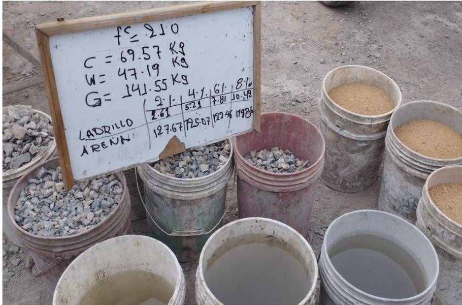
**Ilustración 7. Materiales para elaboración de muestras de concreto**
