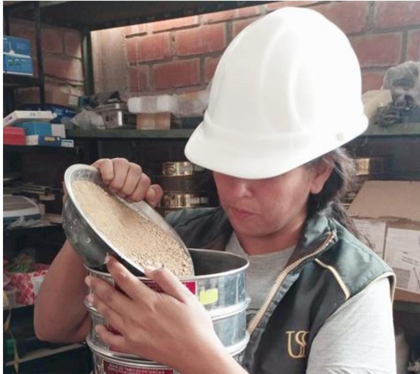
***Ilustración 5. Granulometría del agregado fino***
