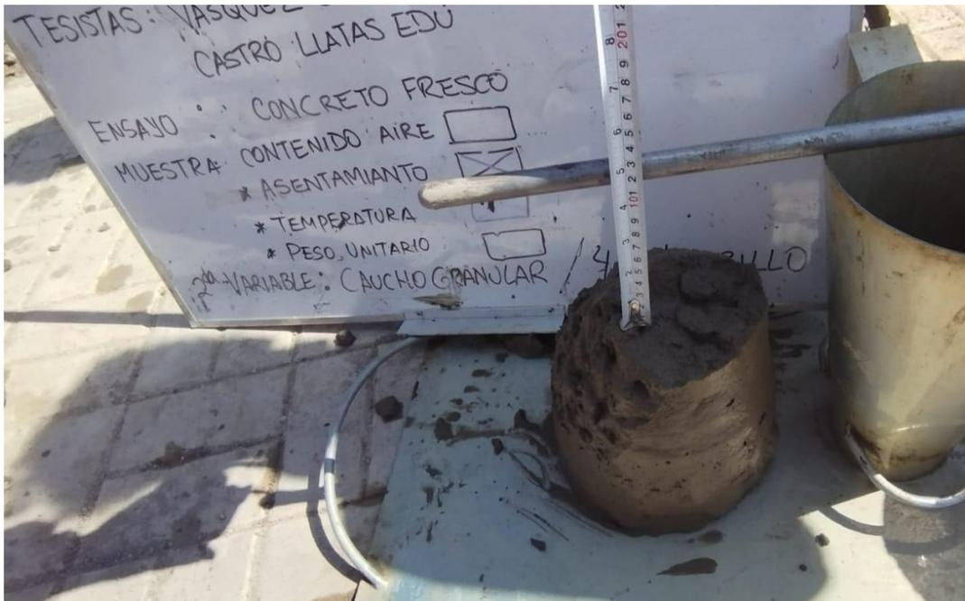
**Ilustración 12. Slump del concreto**
