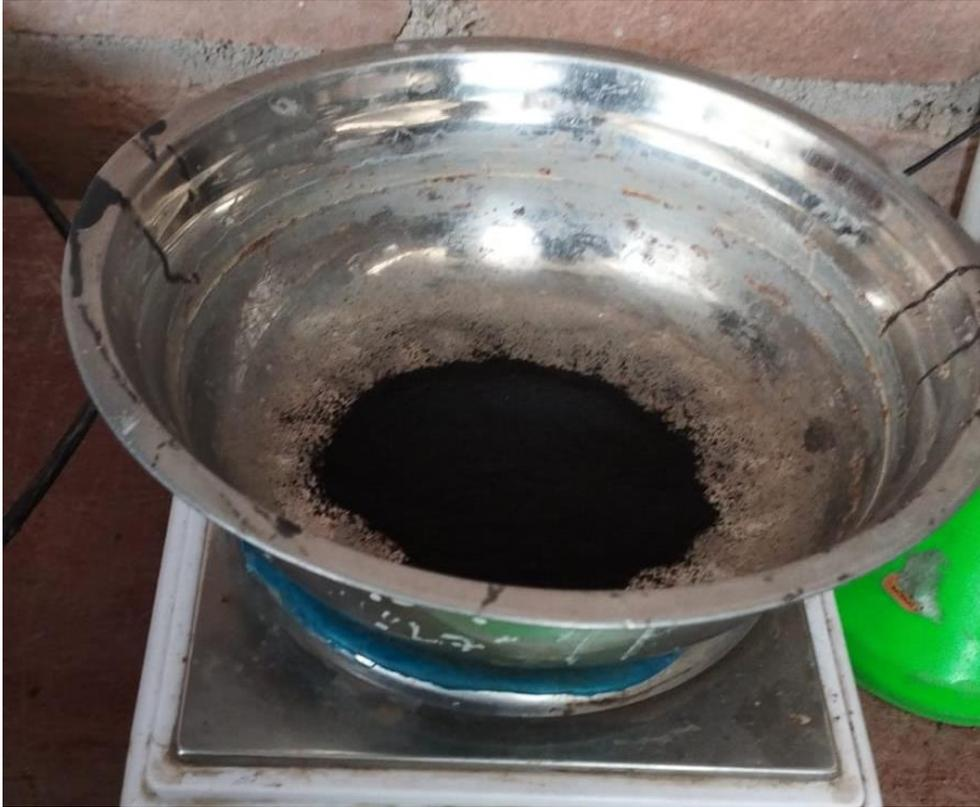
***Ilustración 3. Peso de granulometría del caucho granulado***
