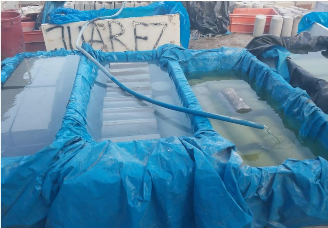
**Ilustración 10. Curado de muestras de concreto**
