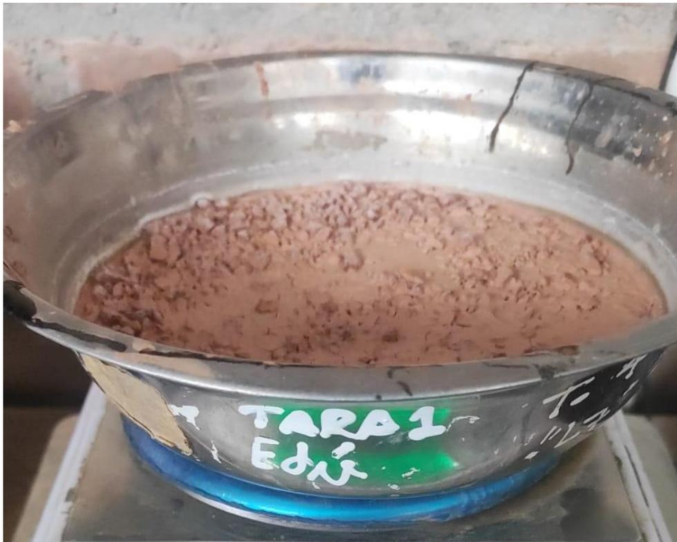
***Ilustración 4. Ladrillo reciclado para ensayo de absorción y peso específico***
