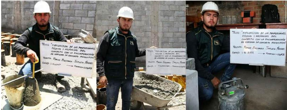
**Fig. a4.** Análisis físicos al concreto en estado fresco – Temperatura, Slump, Densidad y Porcentaje de aire.
