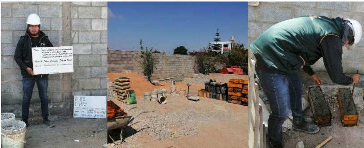
**Fig. a3.** Elaboración de muestras de concreto cilíndricas y prismáticas.
