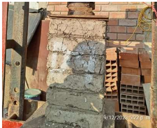
Fig. 14. Resistencia a la compresión en prismas de tierra
