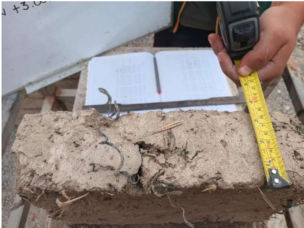
Ilustración 11. Variación dimensional del adobe
