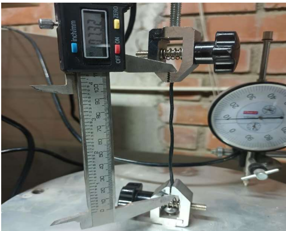
Ilustración 6. Tensión del HDPE
