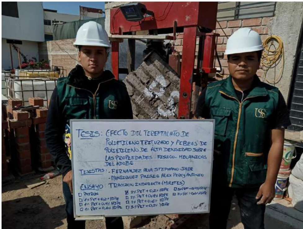
Ilustración 16. Compresión diagonal de muretes de adobe
