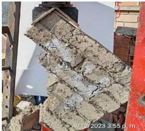
Fig. 17. Compresión Diagonal en muretes de tierra
