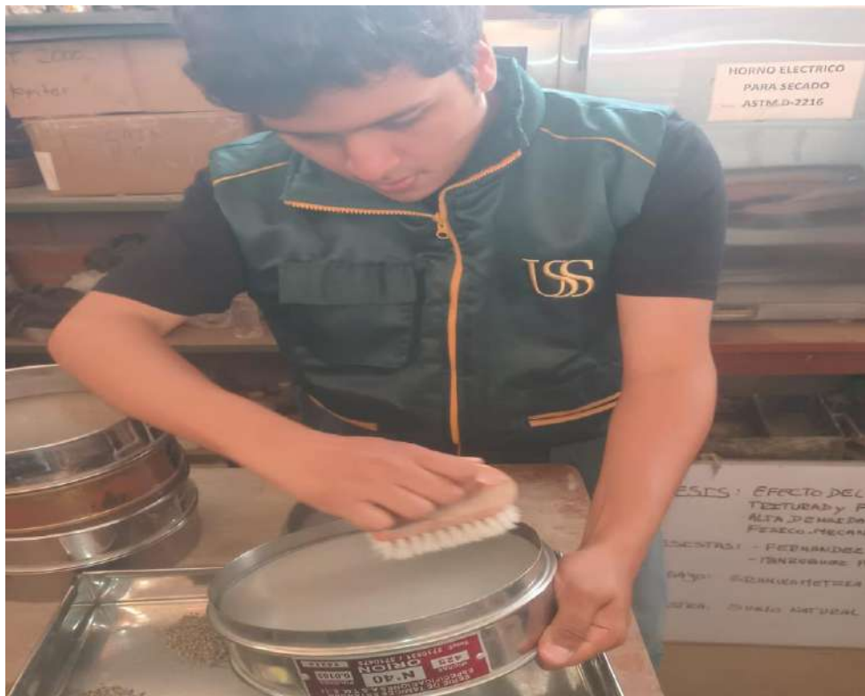
Ilustración 1. Granulometría del suelo
