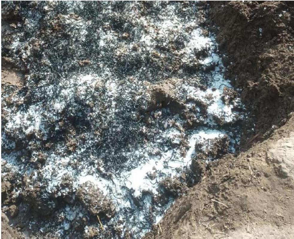
Ilustración 7. Elaboración de adobes con PET triturado y HDPE en fibras
