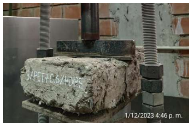
Fig. 11. Resistencia a flexión de la unidad de adobe
