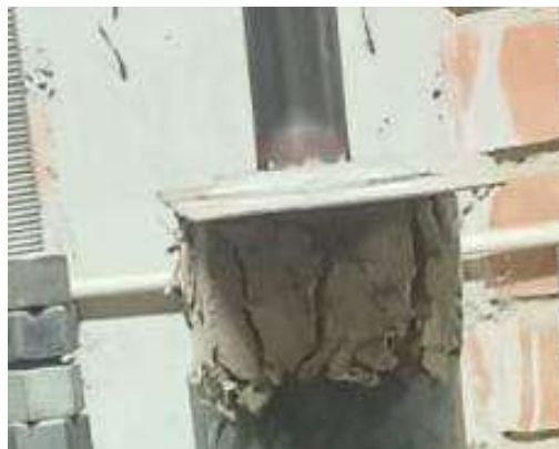
Fig. 8. Resistencia a compresión del cubo de adobe
