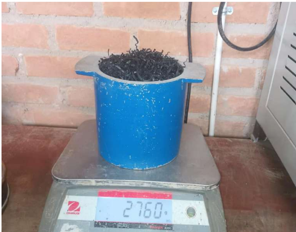
Ilustración 4. Peso Unitario del HDPE
