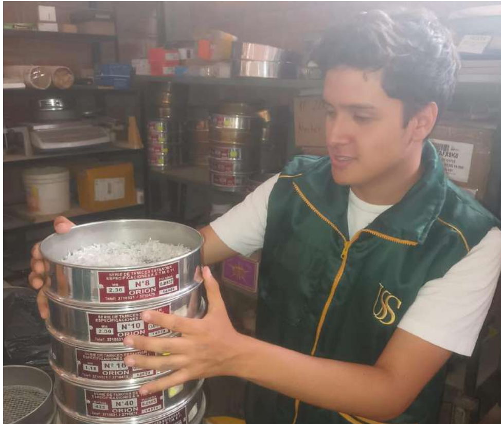
Ilustración 5. Granulometría del PET triturado
