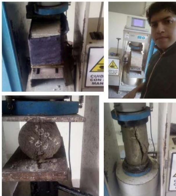
FOTO 8: Ensayos mecánicos en estado endurecido
