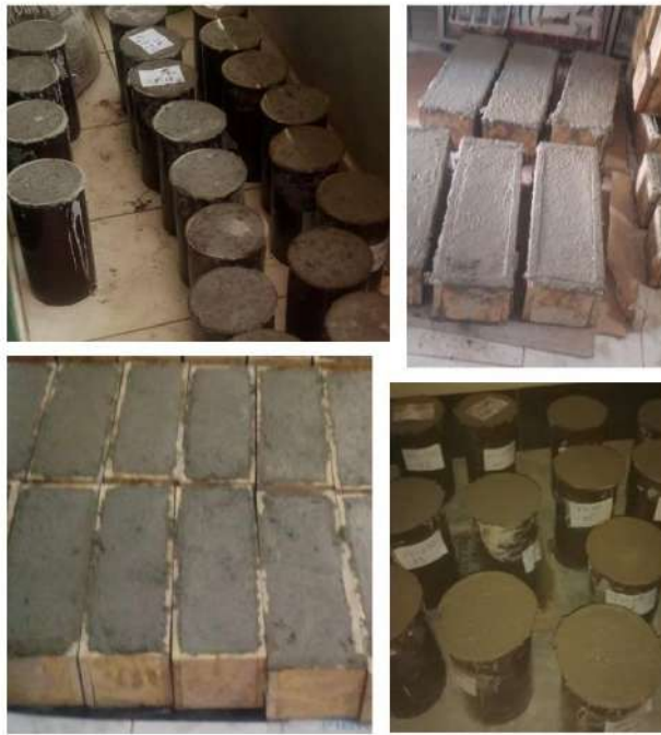
FOTO 5: Llenado de probetas y vigas
