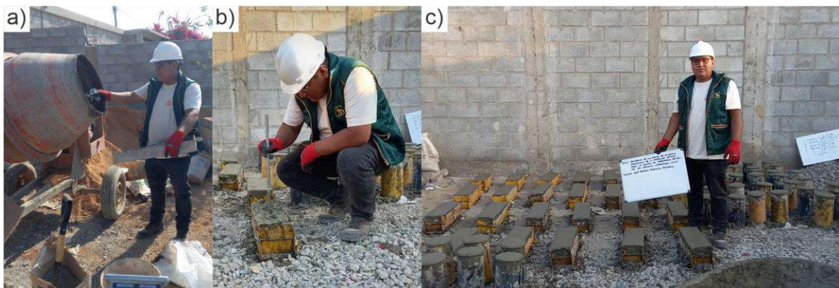
Fig. 14. Adición de FPA GIO, b) Vibrado de viga, c) Probetas y vigas
