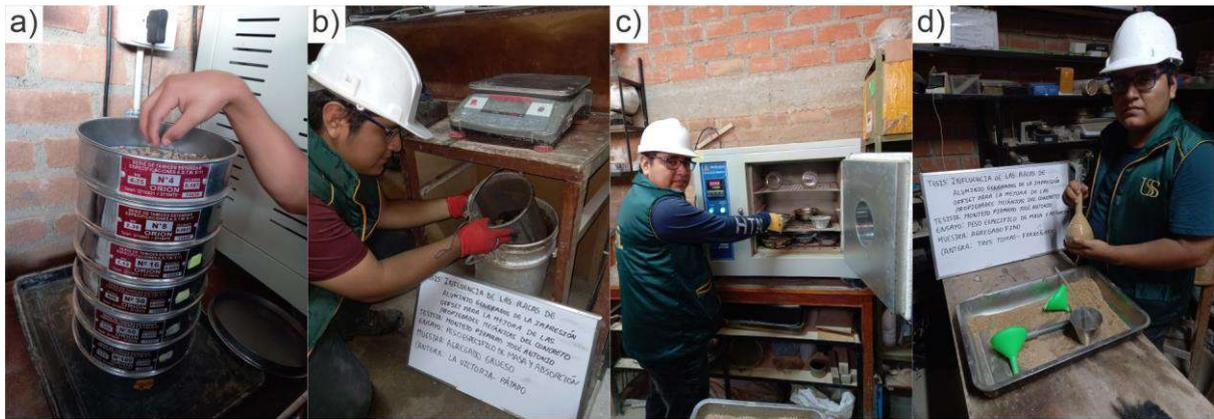
Fig. 12. a) Granulometría de AF, b) Peso específico y absorción de AG, c) Contenido de humedad de AF, d) Peso específico y absorción de AF
