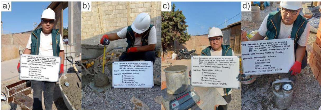
Fig. 15. a) Temperatura, b) Asentamiento, c) Peso Unitario del concreto, d) % Aire
