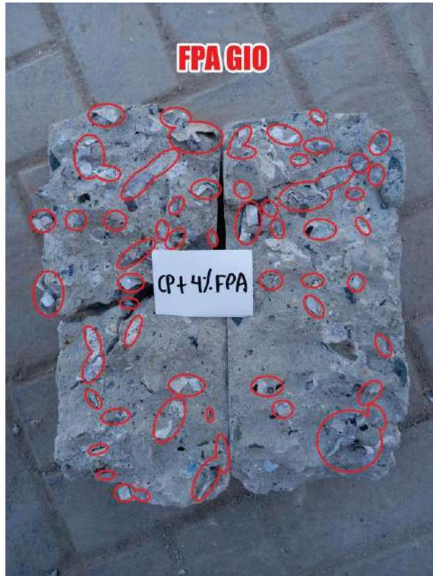
Fig. 18. Estructura interna de adición óptimo (4% FPA GIO)
