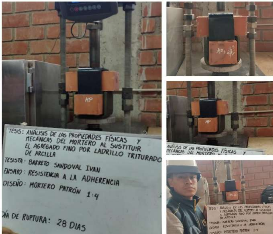
FOTO- Ensayo de resistencia a la adherencia
