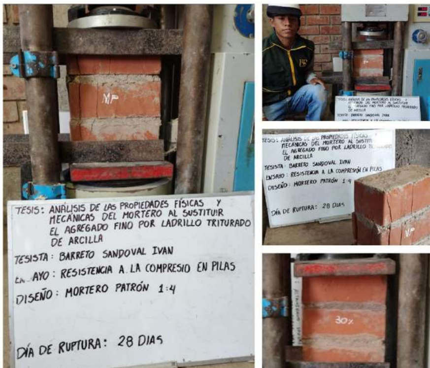
FOTO-Ensayo de resistencia a la compresión en pilas
