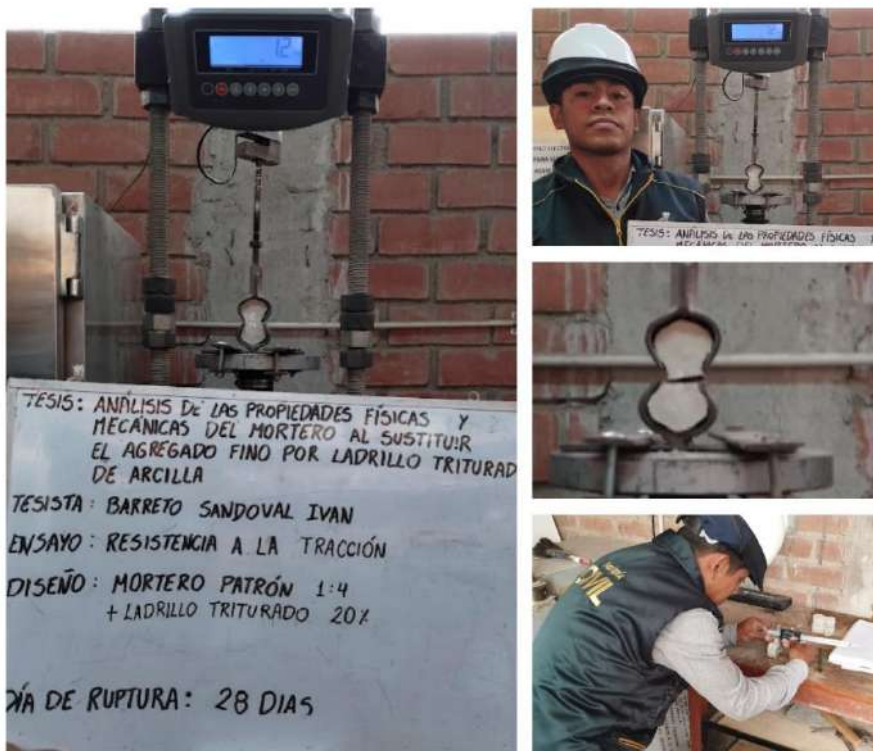
FOTO- Resistencia a la tracción en morteros
