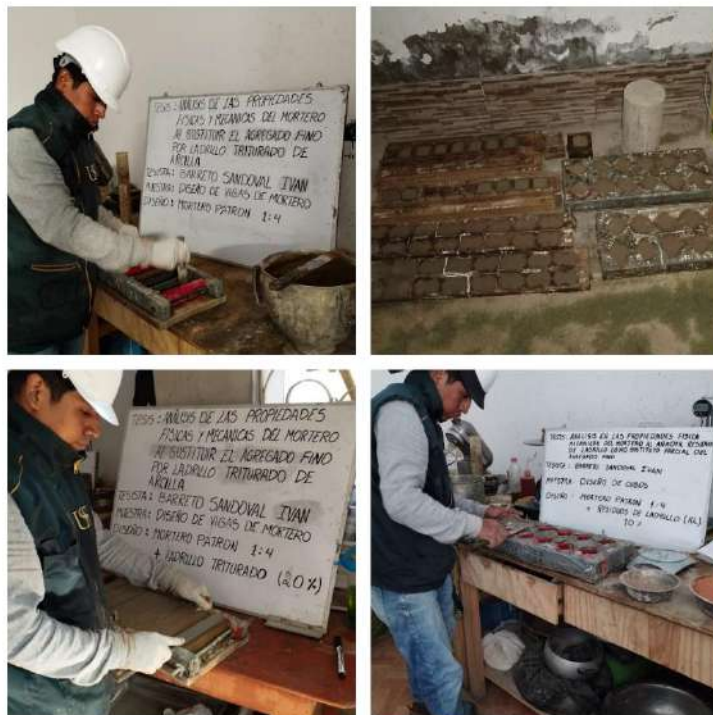
FOTO – Preparación de la mezcla para los ensayos al mortero
