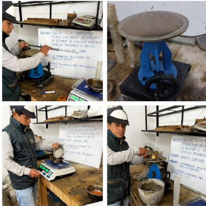
FOTO- Ensayos del mortero en estado fresco (fluidez)
