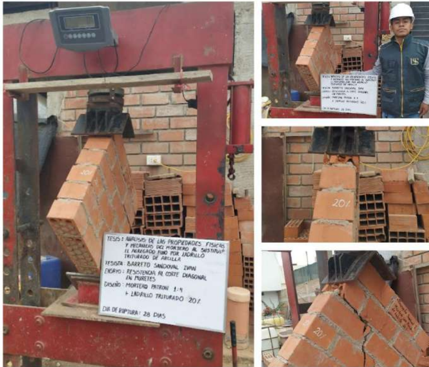
FOTO-Ensayo de resistencia a la compresión diagonal en muros
