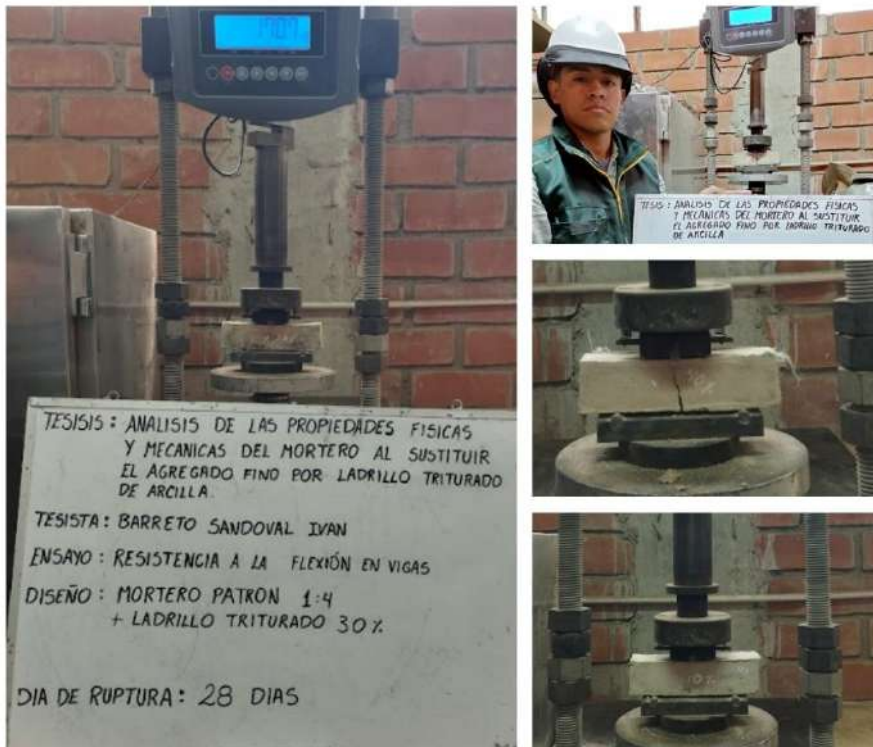
FOTO- Resistencia a la flexión en morteros
