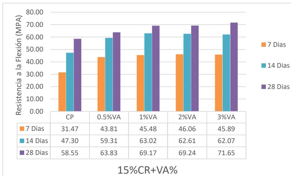
**Fig. 32** Evaluación de Resistencia a Flexión con 30% CR + % VA
