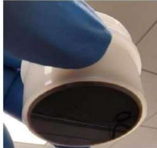
**Figura 1.** Fotografía de la muestra AM colocada en el porta muestras para análisis de líquidos por XRF.
