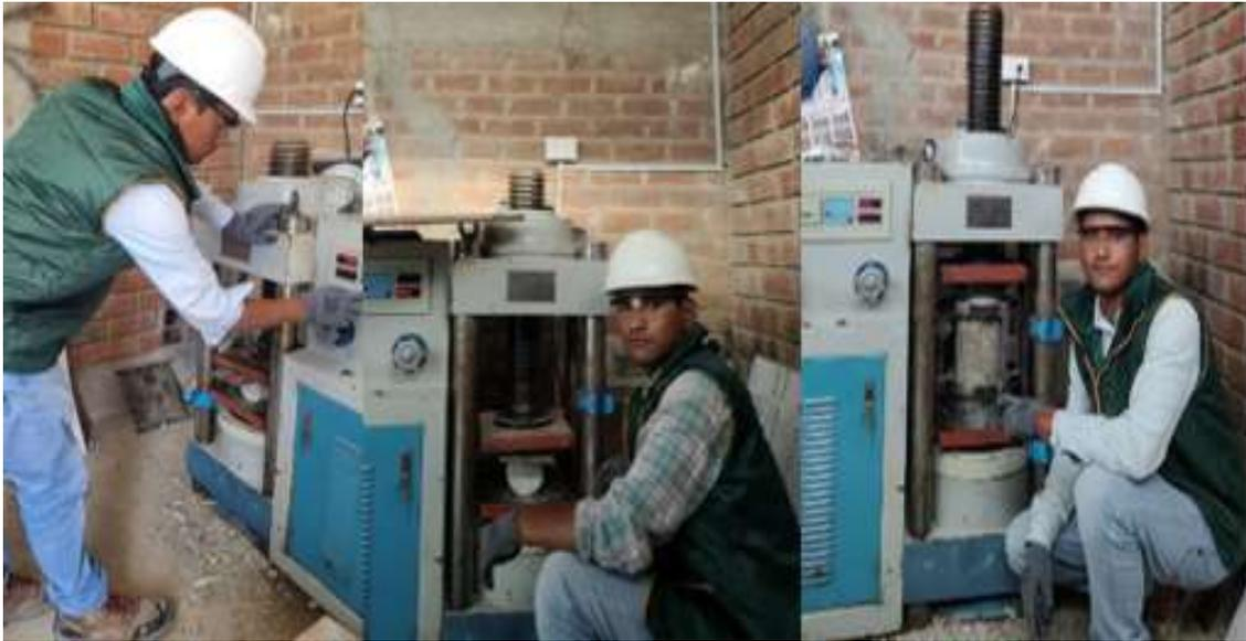
**Fig. 19.** Ensayo de resistencia a la compresión y tracción
