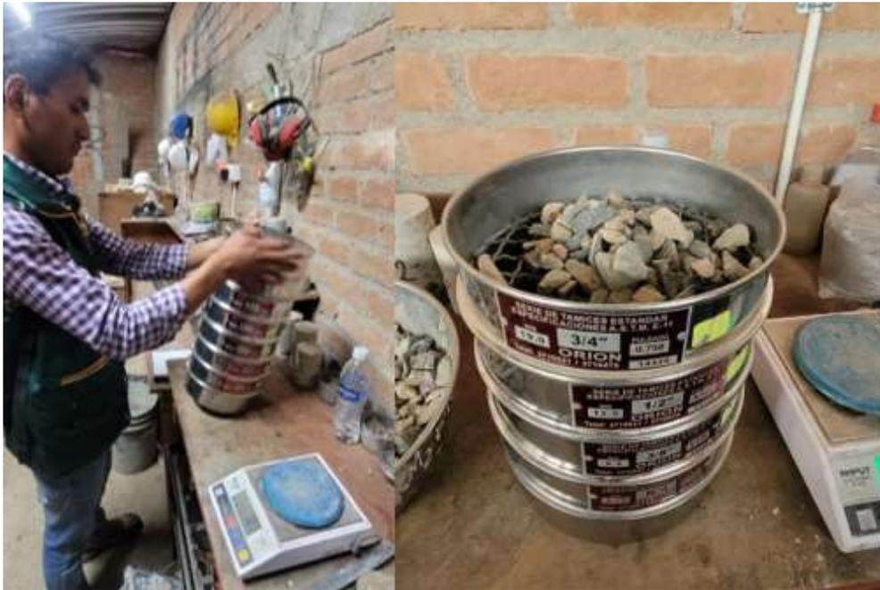
Fig. 11 Ensayo de granulométrico
