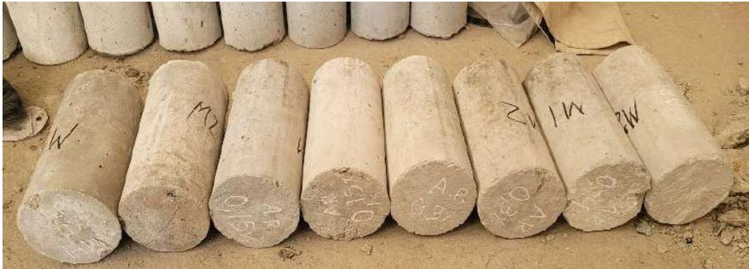
**Fig. 21.**Muestras de concreto de forma cilíndrica ensayadas
