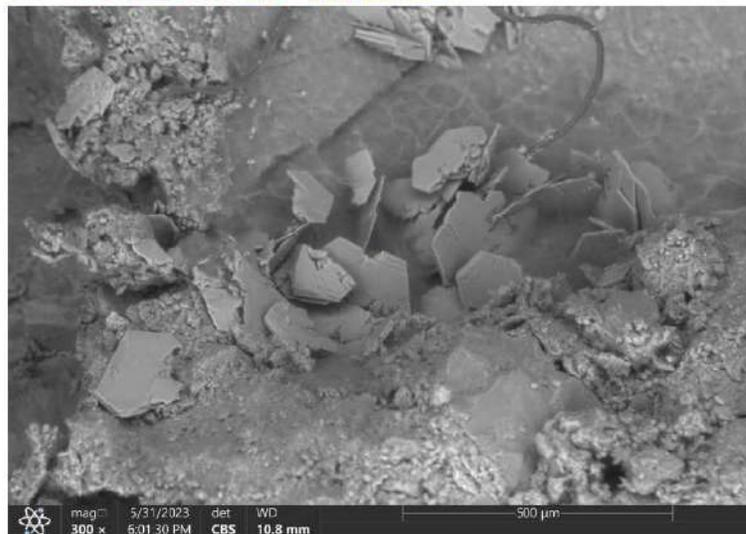
**Figura 7.** Micrografía de la muestra de “concreto con aceite” a una magnificación de 300x (señal de electrones retrodispersados).
