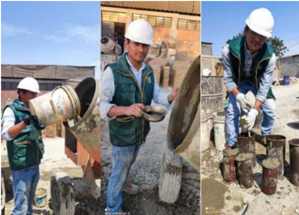
**Fig. 16** Preparación de la mezcla, adición de UEO a la mezcla y moldeado de muestras.
