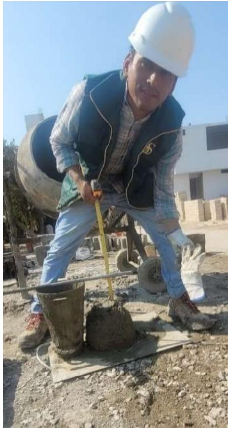
**Fig. 17** Ensayo de asentamiento del concreto fresco
