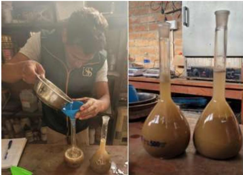
**Fig. 14** Ensayo de Peso específico y Absorción del agregado fino
