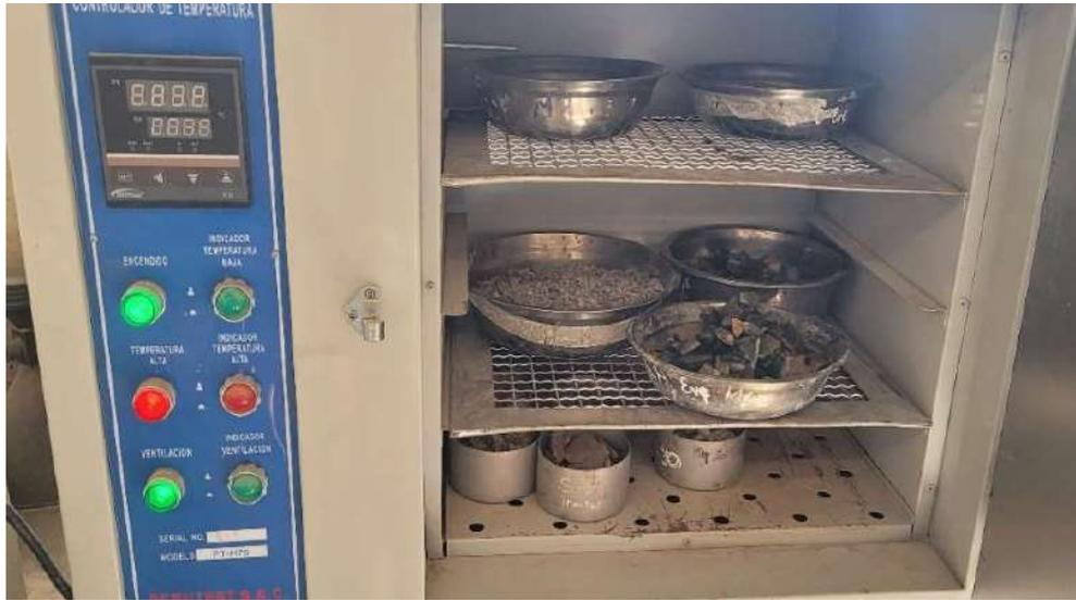
**Fig. 13** Muestra de los agregados colocado en el horno
