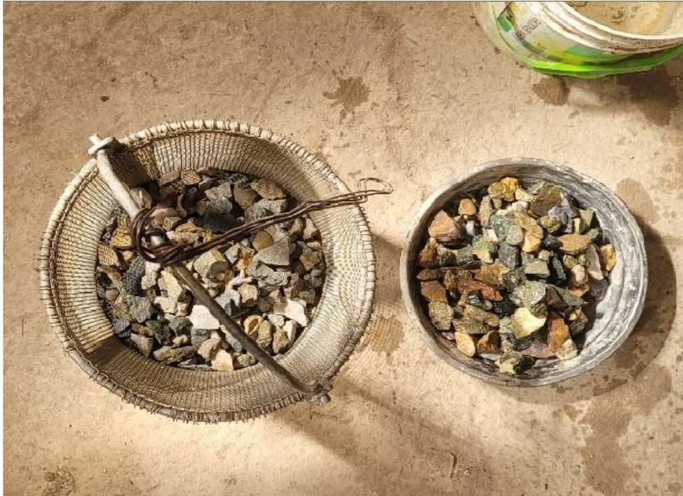
**Fig. 15** Ensayo de Peso específico y Absorción del agregado grueso
