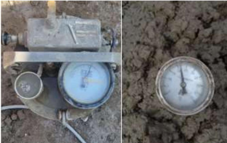
**Fig. 18** Ensayo del contenido de aire y temperatura
