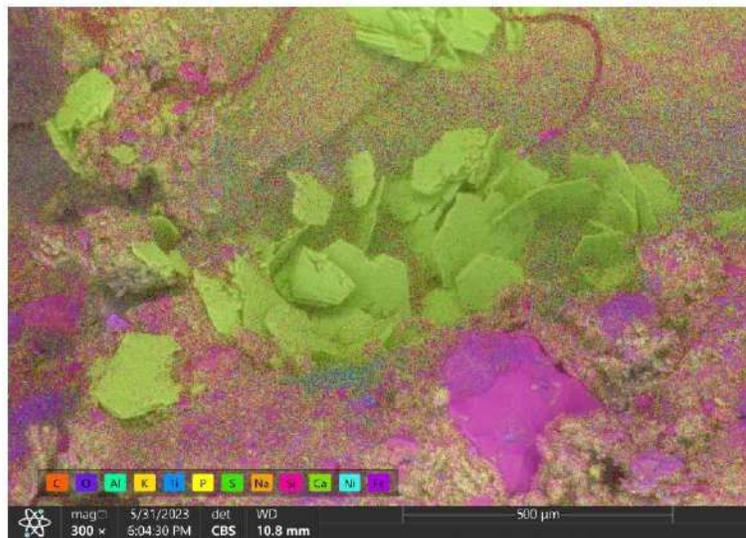
**Figura 8.** Micrografía de la muestra de “concreto con aceite” a una magnificación de 300x (señal de electrones retrodispersados), superpuesta con los resultados del mapeo EDS.
