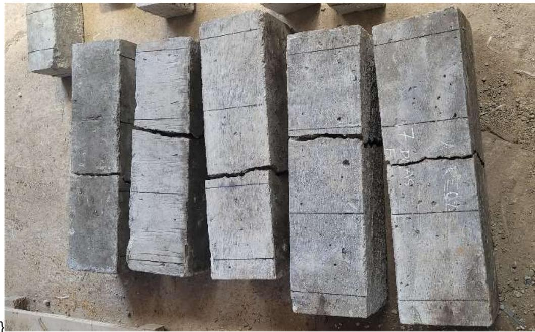
**Fig. 22.**Muestras de concreto de tipo viga ensayadas
