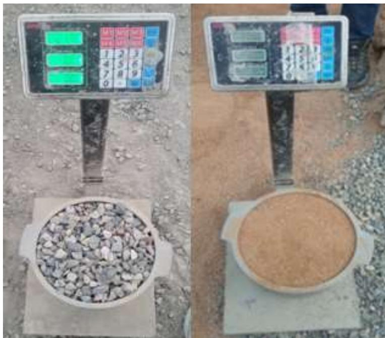
Fig. 12 Ensayo de peso unitario suelto y compactado del agregado grueso.
