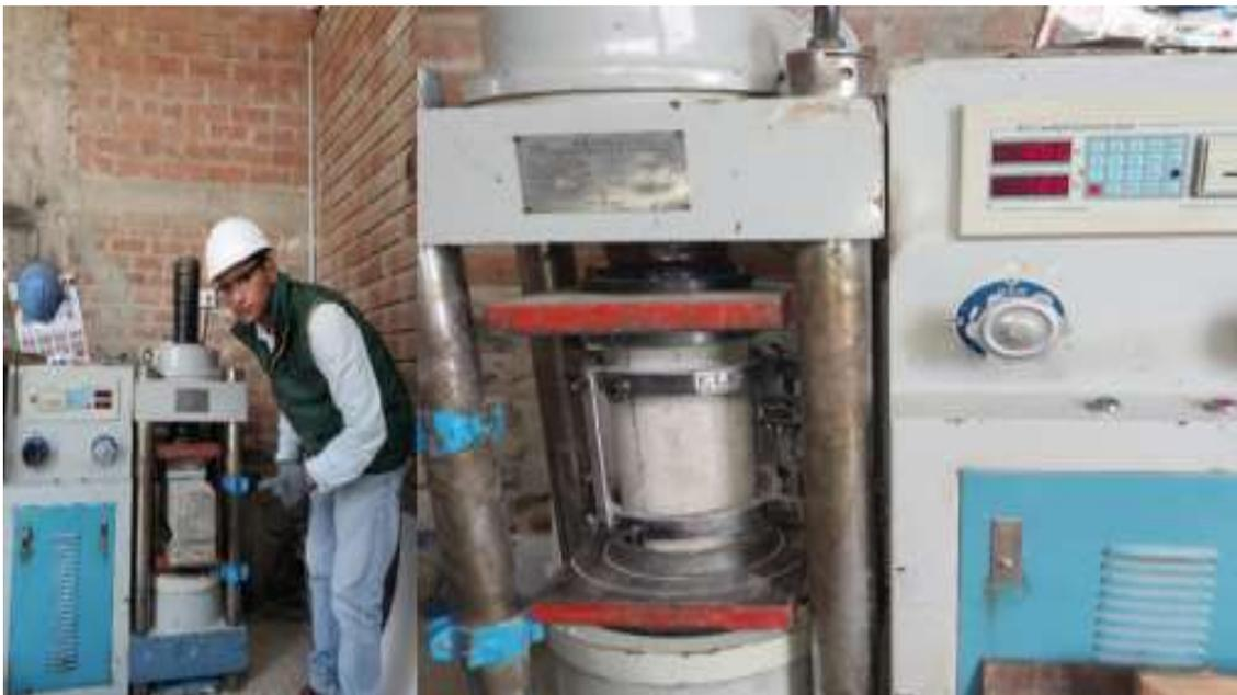
**Fig. 20.** Ensayo de resistencia a la flexión y módulo de elasticidad
