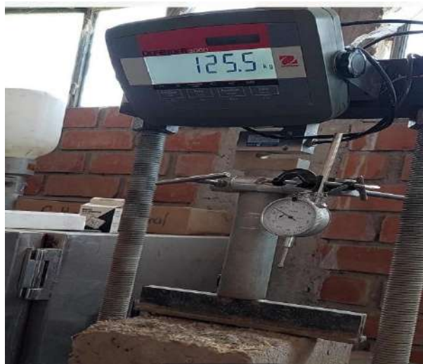
Fig. 8 Equipo donde se realizarán los ensayos de flexión a cada unidad de adobe.
