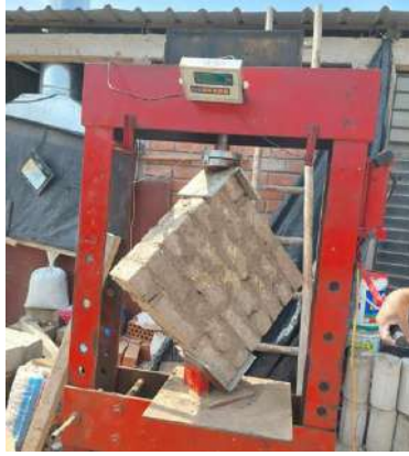
Fig. 7 Equipo donde se realizarán los ensayos de Compresión diagonal en muros
