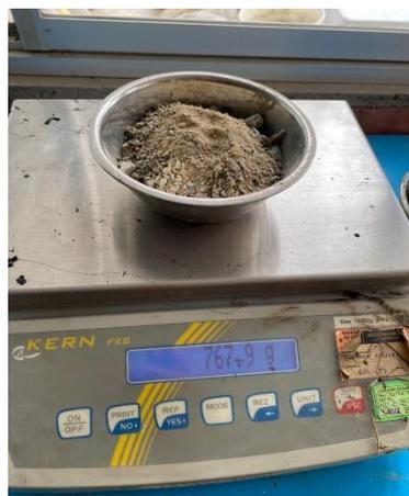
*Pesaje de materiales para mezcla asfáltica patrón*
