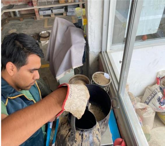
*Añadir líquido asfáltico a los agregados*
