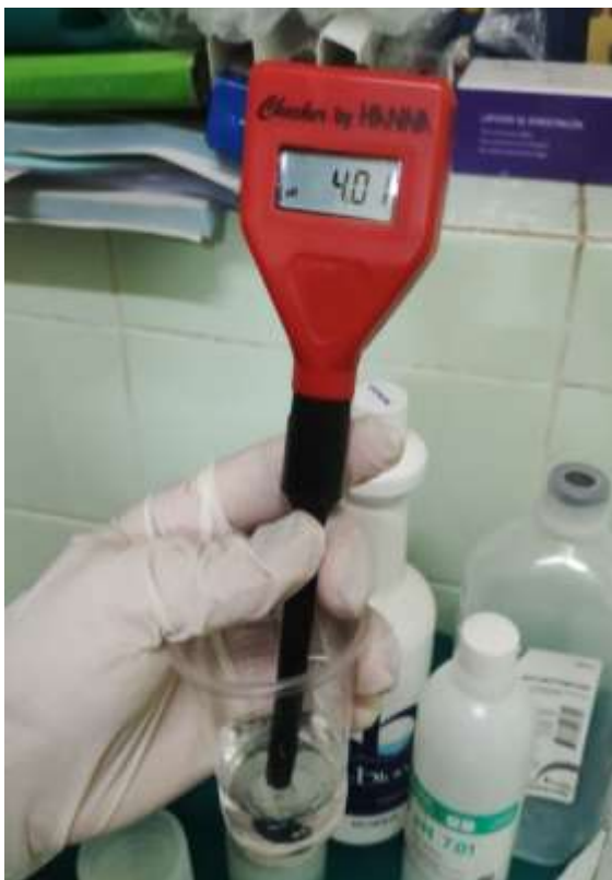
Imagen 2: Calibración del pH metro Digital.
