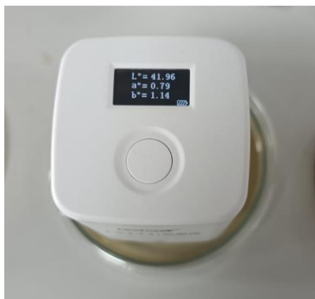
Colorímetro con la muestra de aceite.
