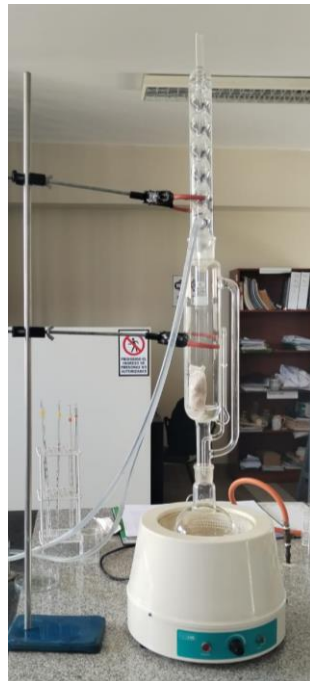
Dispositivo de extracción Soxhlet con cartucho.
