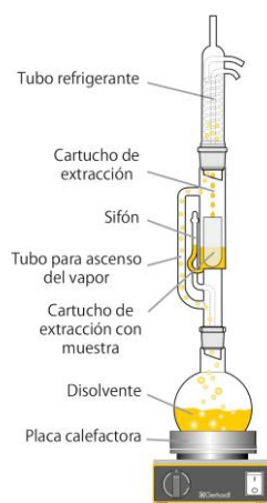
Dispositivo de extracción Soxhlet
