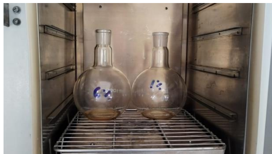
Evaporación de restos de éter de petróleo.
