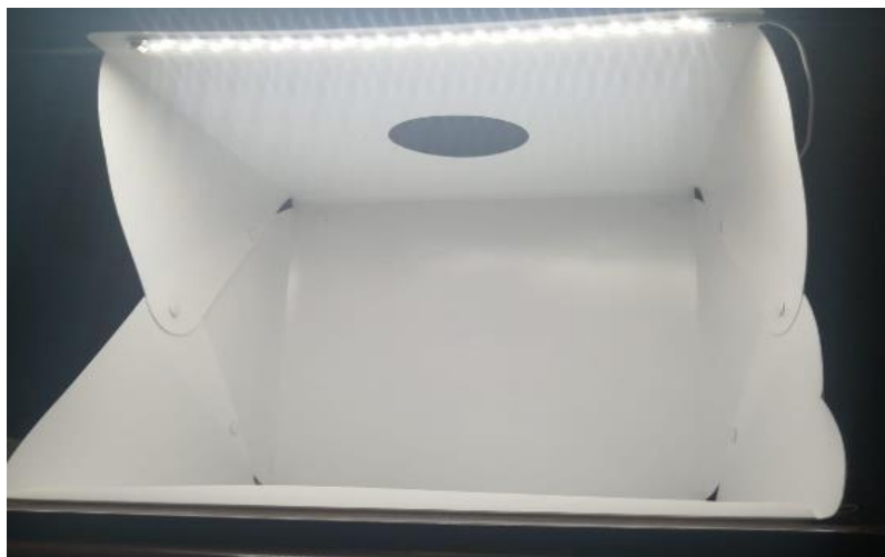
Figura 14: Posición de las luces LED blancas en la caja de luz foto estudio.
