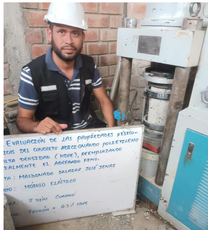
Ensayo de módulo de elasticidad del concreto
