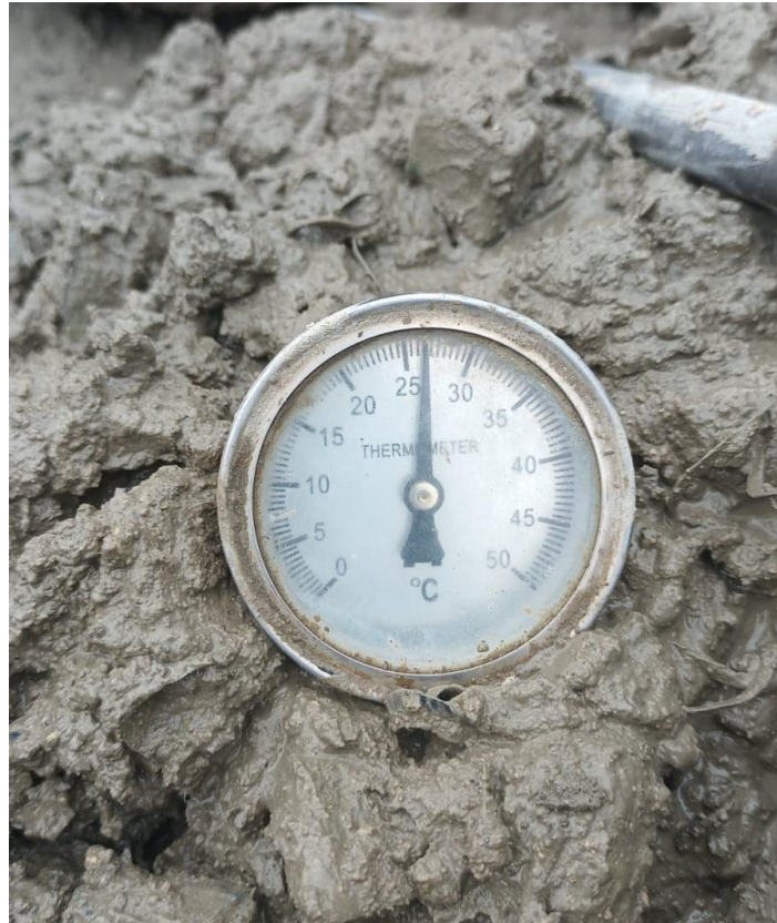
Temperatura del concreto
