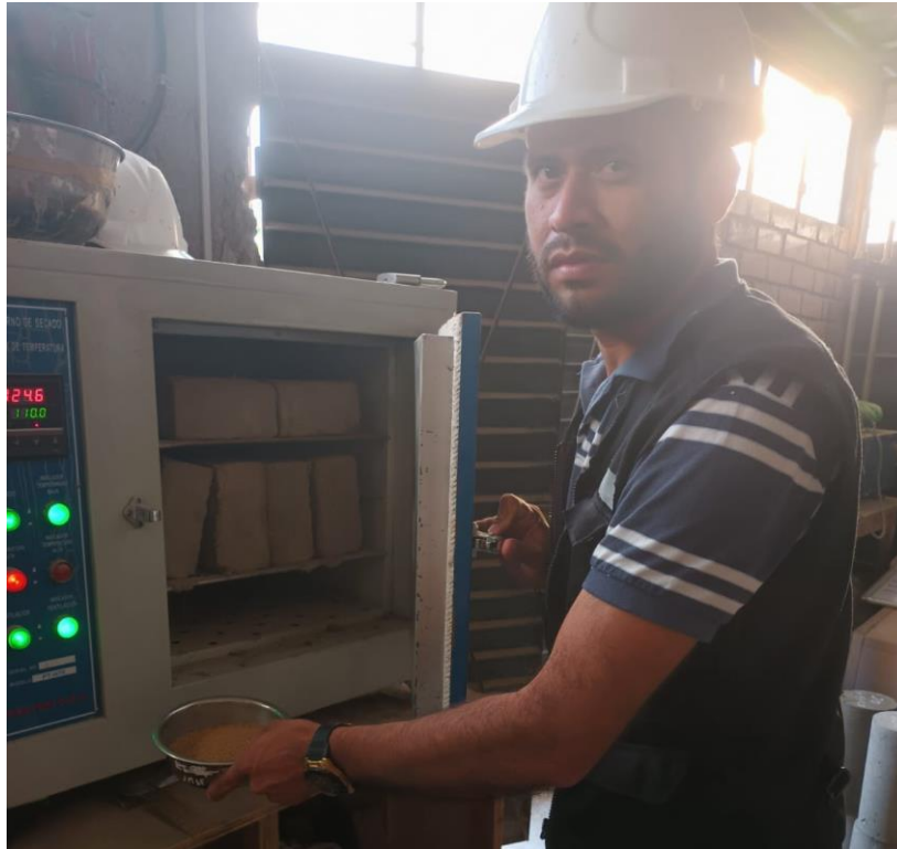
Agregado fino al horno para ensayo de humedad
