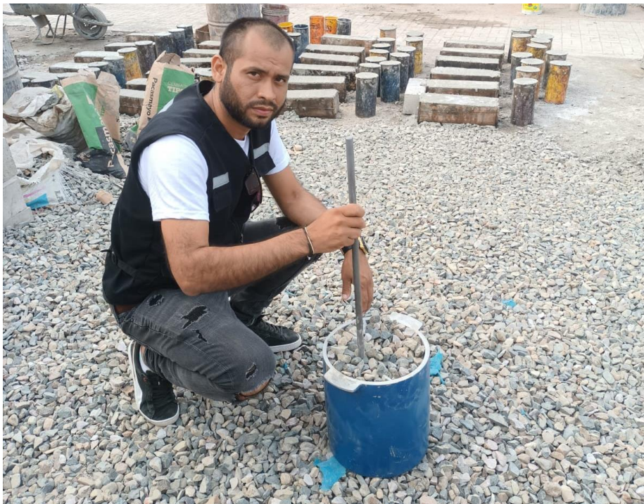
Peso unitario compactado del agregado grueso
