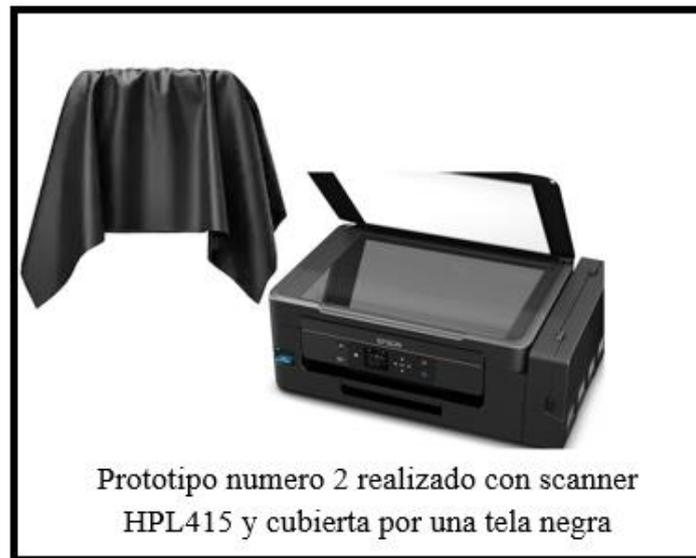
Fig. 30 Prototipo “DOS” con el Scanner HP L415 en un ambiente controlado para la adquisición de imágenes de la palma de las manos. Fuente, Elaboración Propia
