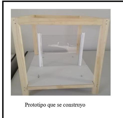
Fig. 28 Prototipo “uno” de ambiente controlado para la adquisición de imágenes de la palma de las manos. Fuente: Elaboración Propia
