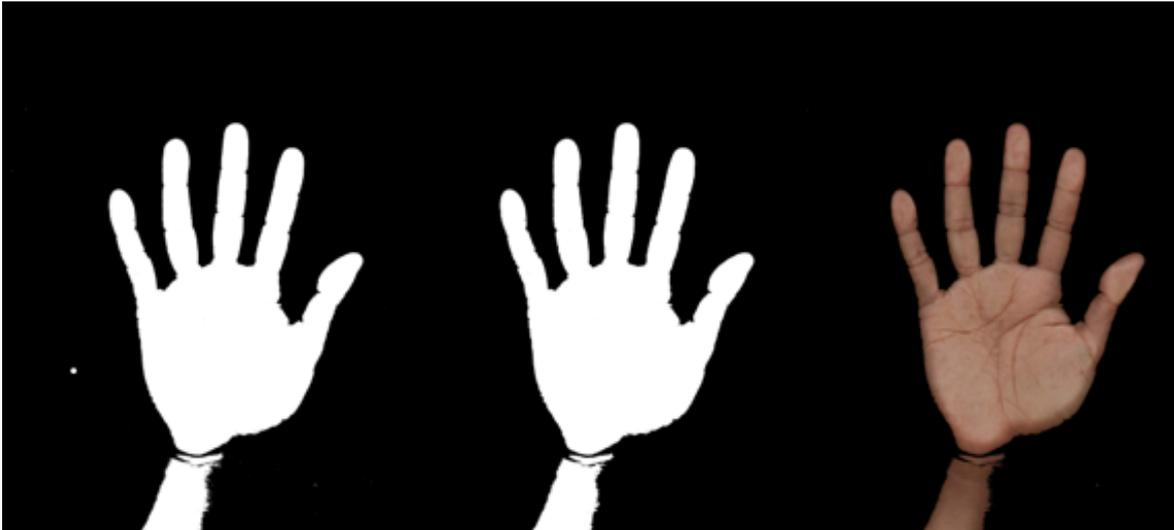
Fig. 31 Resultado de Implementación del algoritmo de Otsu. Fuente: Elaboración Propia
