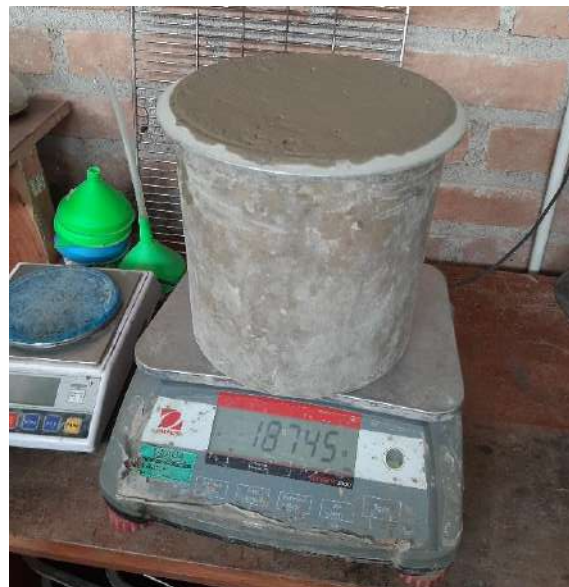
Fig. 60 Peso unitario de concreto en estado fresco
