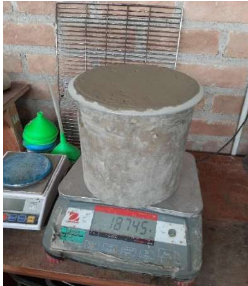
Fig. 17. Ensayo de Peso Unitario.
