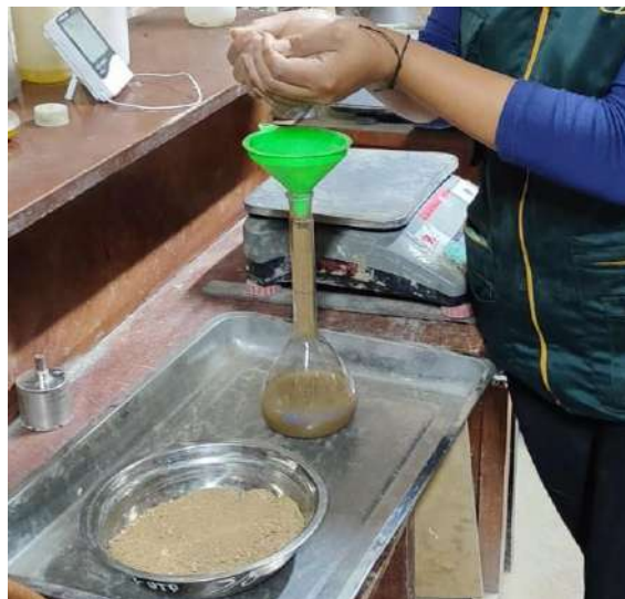
Fig. 12. Peso específico y absorción del AF
