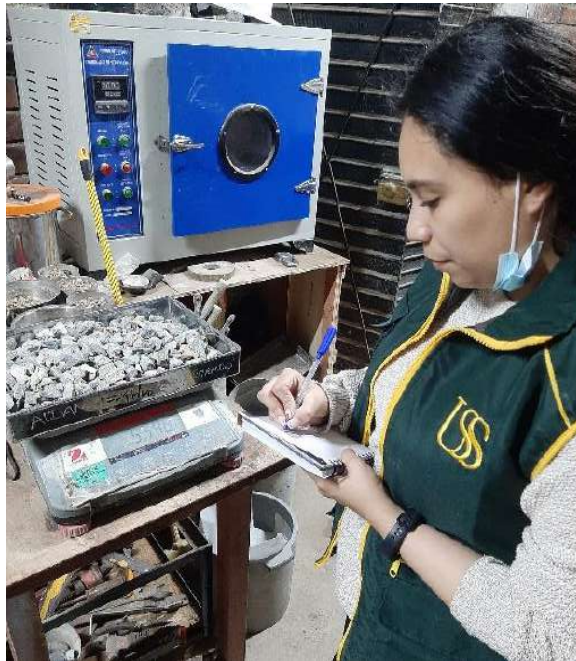
Fig. 14. Peso específico y absorción del AG
