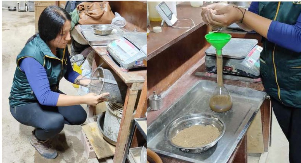
Fig. 57 Muestras de los agregados para ensayo de peso específico y absorción
