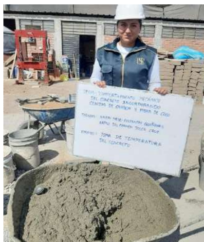
Fig. 16. Temperatura del concreto
