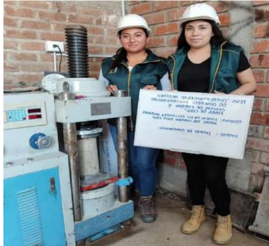
Fig. 19. Ensayo de Resistencia a la Compresión.
