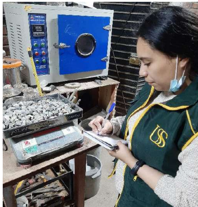
Fig. 56 Muestras de los agregados para ingresarlos al horno
