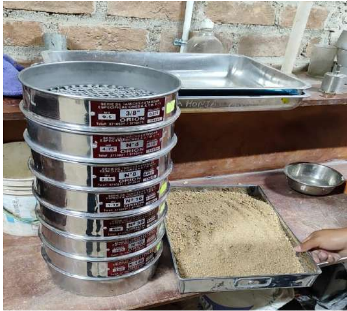
Fig. 53 Granulometría de agregado fino
