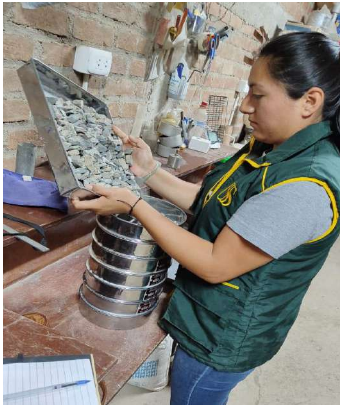
Fig. 54 Granulometría de agregado grueso
