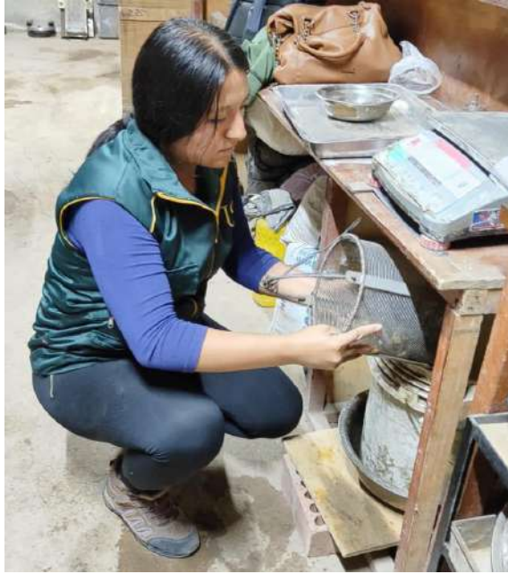
Fig. 13. Colocación del AG en la canastilla sumergida en agua
