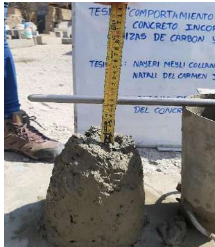
Fig. 15. Prueba de asentamiento
