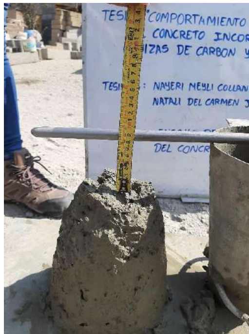
Fig. 58 Asentamiento del concreto en estado fresco
