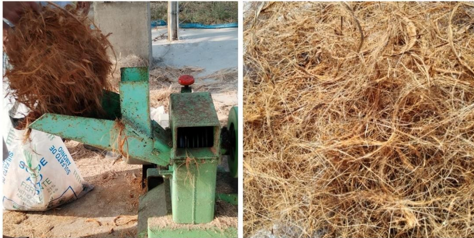
Fig. 3: Fibra de coco (a) proceso de corte y (b) fibra en hilos.
