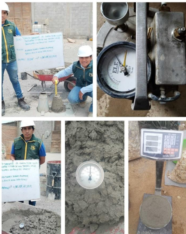
FOTO- Ensayos al concreto en estado fresco
