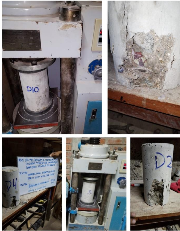
FOTO- Ensayo a compresión
