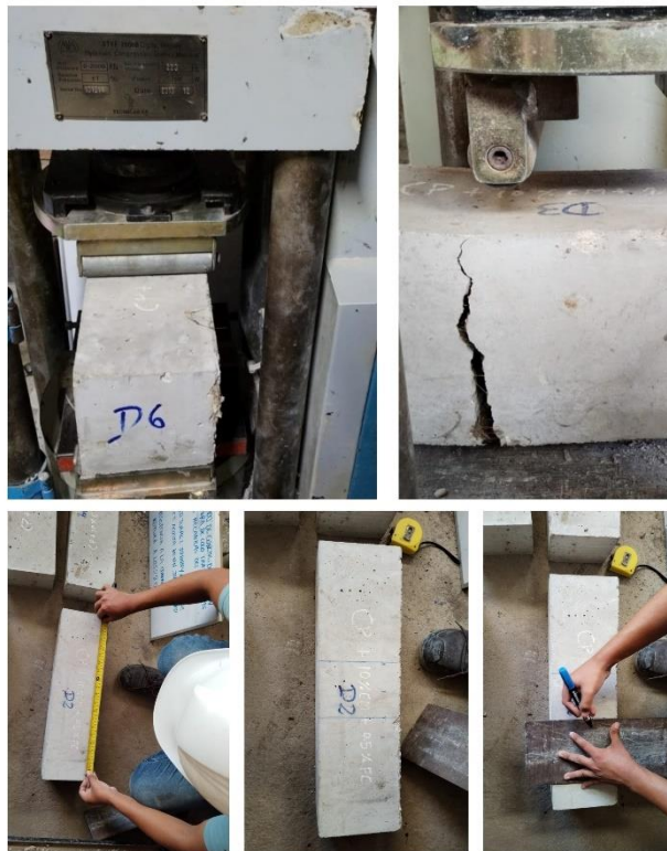
FOTO- Ensayo a flexión
