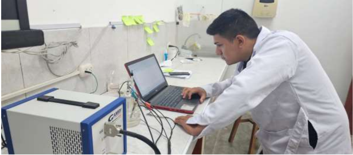
Figura 1 Potenciostatos Gamry 3000 en operación a 25 °C con una solución 0.1 M HCL.
