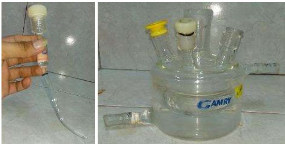
FIGURA2. 4 Capilar de Luggin y celda Gamry de 3 electrodos para ensayos electroquímicos
