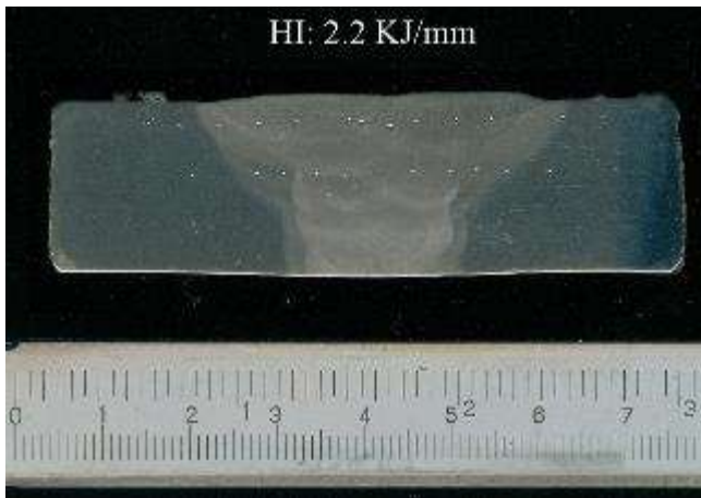
FIGURA 2. 2 . Macrografías del acero ASTM 572 G50, soldado con el electrodo AWS E1108-G mediante el proceso SMAW con un calor de aporte (a) 1.2 kJ/mm y (b) 2.2 kJ/mm.
