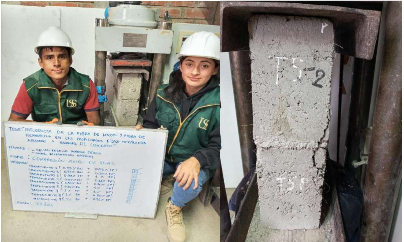
Fotografía 8. Resistencia a la compresión axial de pilas 14 días
