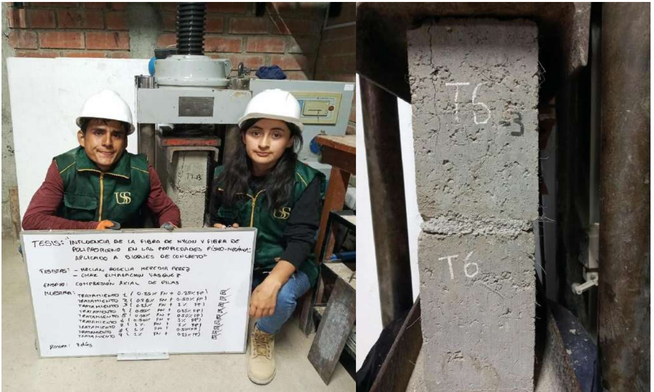
Fotografía 7. Resistencia a la compresión axial de pilas 7 días
