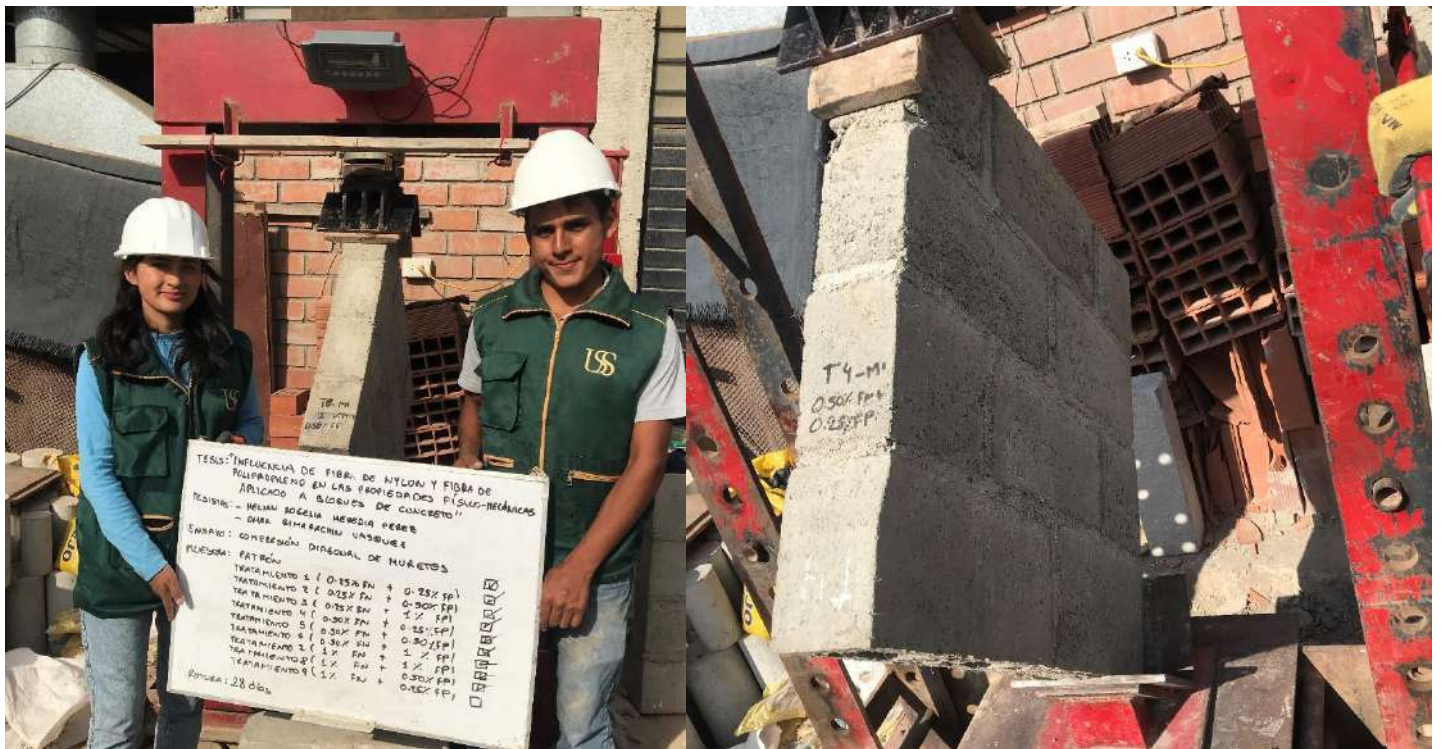
Fotografía 12. Resistencia a la compresión diagonal de muretes 28 días
