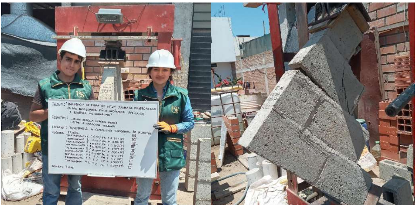
Fotografía 10. Resistencia a la compresión diagonal de muretes 7 días
