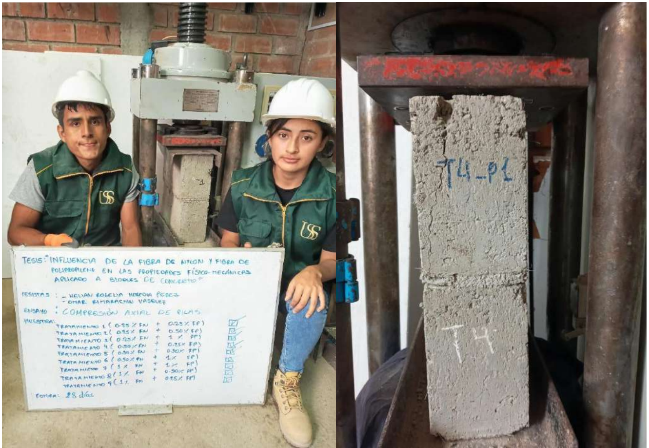
Fotografía 10. Resistencia a la compresión diagonal de muretes 7 días
