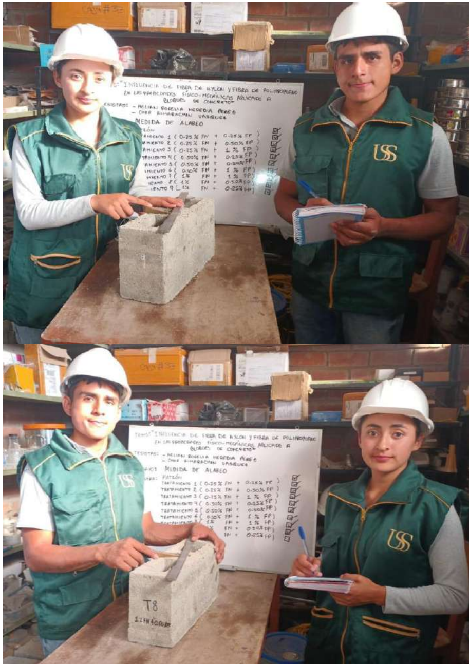
Fotografía 15: Ensayo de Alabeo
