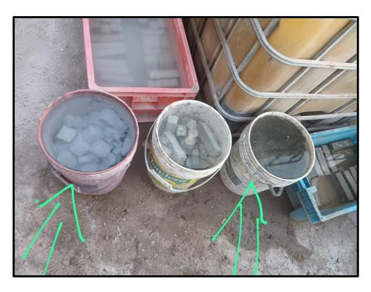
Ilustración 5. Curado de muestras de mortero
