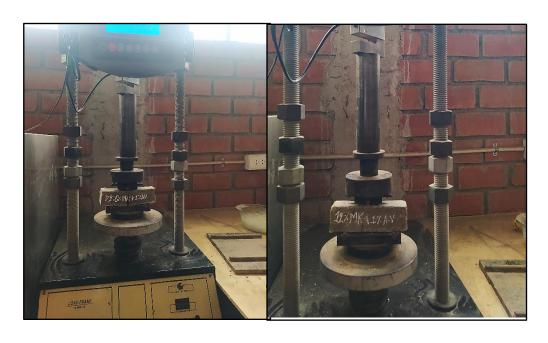
Ilustración 8. Resistencia a la flexión del mortero
