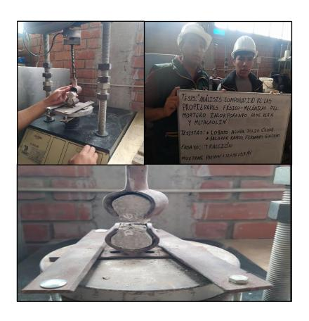
Ilustración 9. Resistencia a la tracción del mortero
