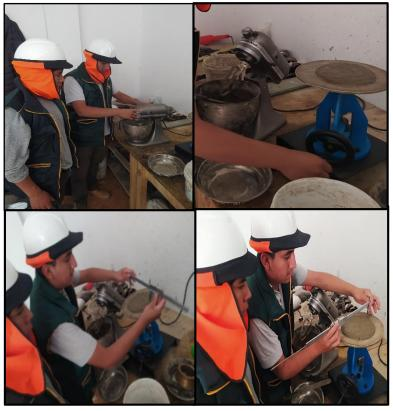
Ilustración 4. Fluidez del mortero
