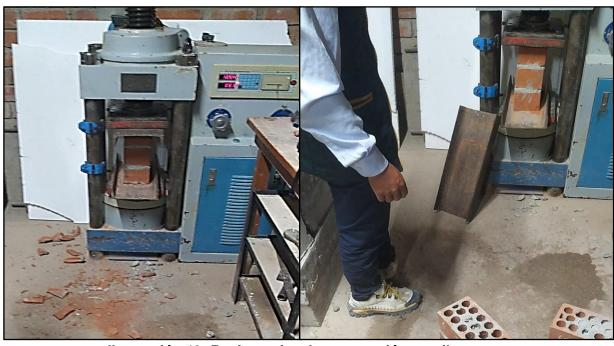
Ilustración 12. Resistencia a la compresión en pilas
