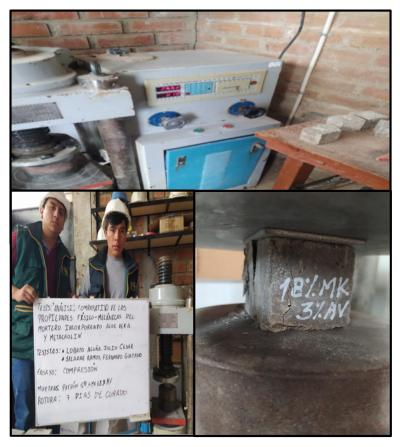
Ilustración 7. Resistencia a la compresión del mortero
