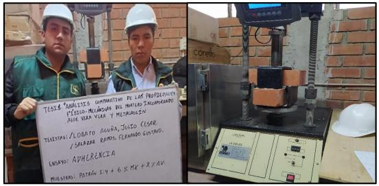
Ilustración 11. Adherencia de la albañilería simple
