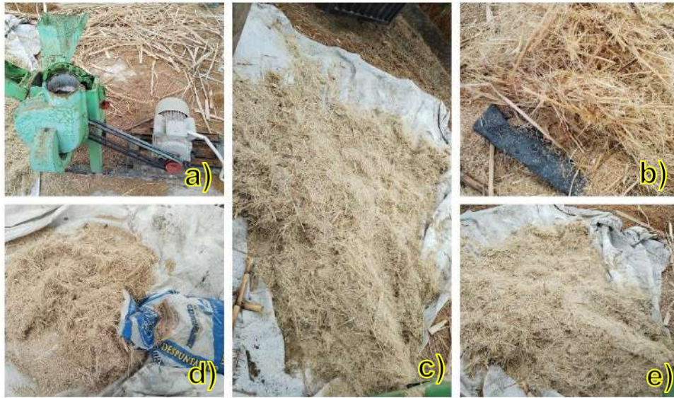
Foto: Bagazo de caña de azúcar BCA, (a)trituración caña de azúcar, (b) extensión de laFCA y (c,d y e) seca de la FCA
