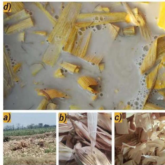
Fig. 3: Obtención de FSM tratada se observa: a) lugar de recojo de la FSM, b) se obtiene FSM, c) el corte manual de la FSM. d) el tratamiento con cal a la FSM.
