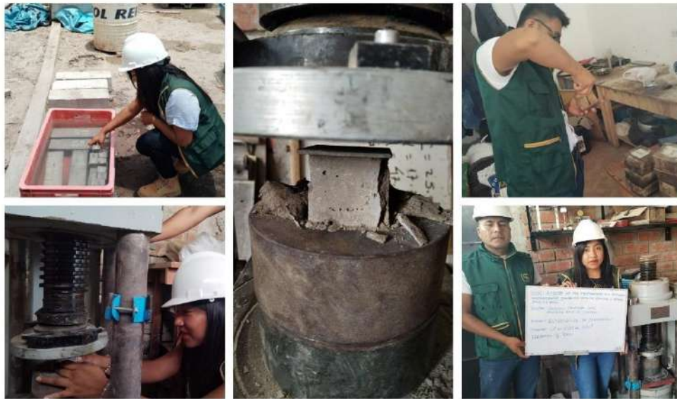
Foto: Curado, desencofrado y rotura de cubos para determinación de temperatura óptima
