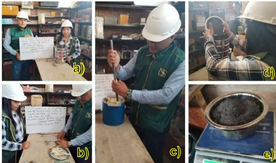
Foto: Ensayo a los agregados, (a)granulometría, (b)corte de FSM, (c) ensayo a la FSM, (d) ye) ensayo a la CBCA
