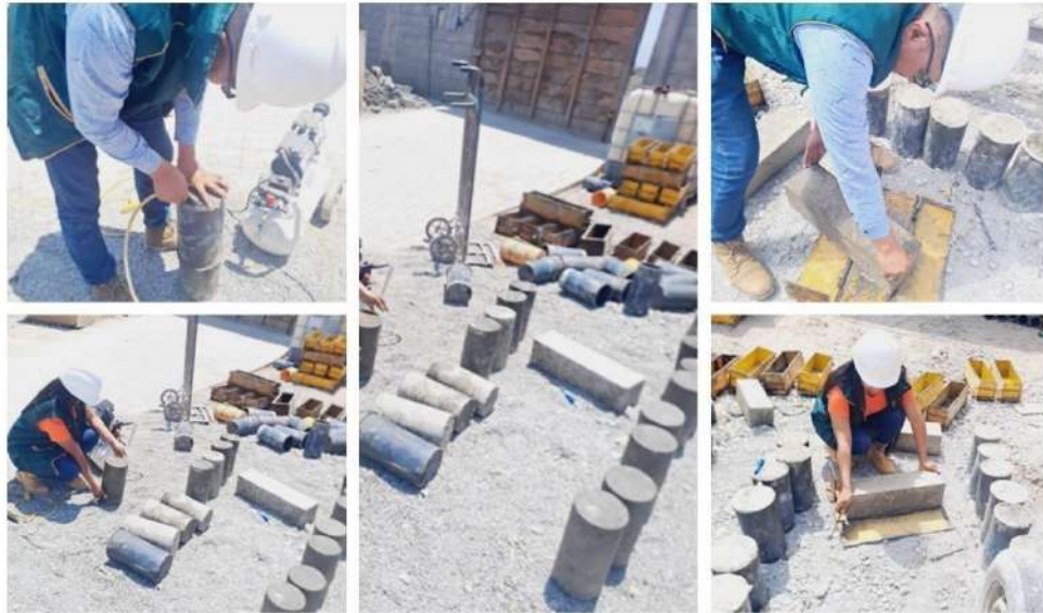
Foto: Desencofrado de probetas cilíndricas y vigas
