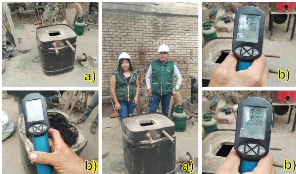
Foto: obtención de CBCA, (a)Horno para realizar el quemado, (b) lecturas de temperatura
