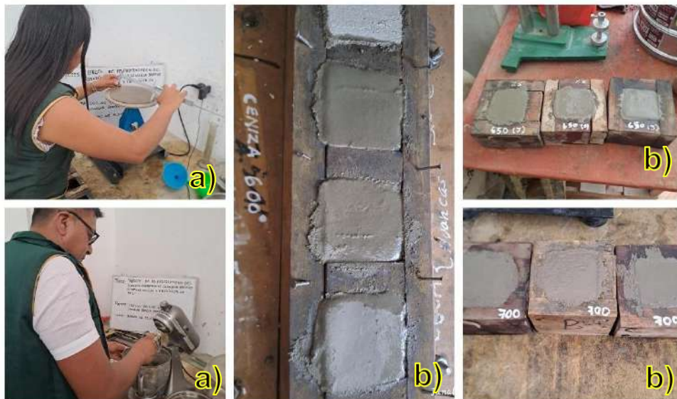
Foto: Llenado de cubos, (a) preparación y ensayo de flujo del mortero, (b)llenado de cubosde mortero con CBCA adicionando en diferentes temperaturas
