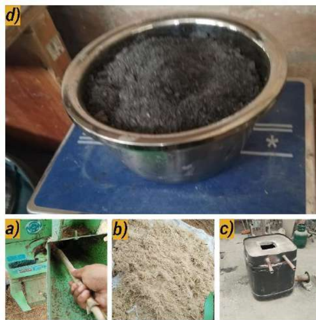
Fig. 2: Obtención de CBCA: (a) la CA para por un molino triturador, (b) se obtiene el BCA, (c) el horno manual para realizar la quema y (d) Obtención de la CBCA
