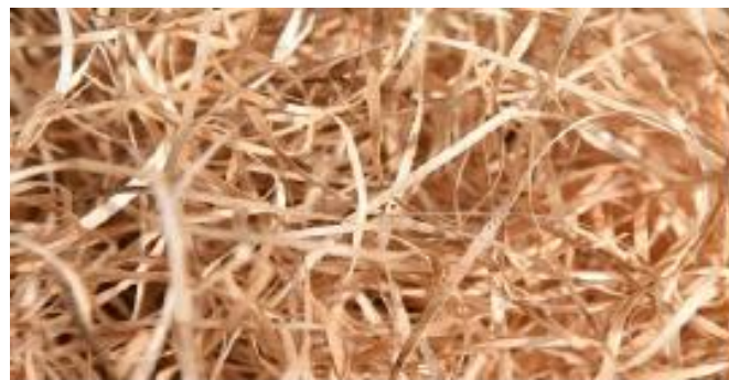
Fig. 4. Fibras de madera (Eucaliptus) para la realización de los diseños de concreto
