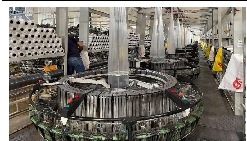
Figura 21: Proceso de tejido Fuente: Atlántica S.R.L
