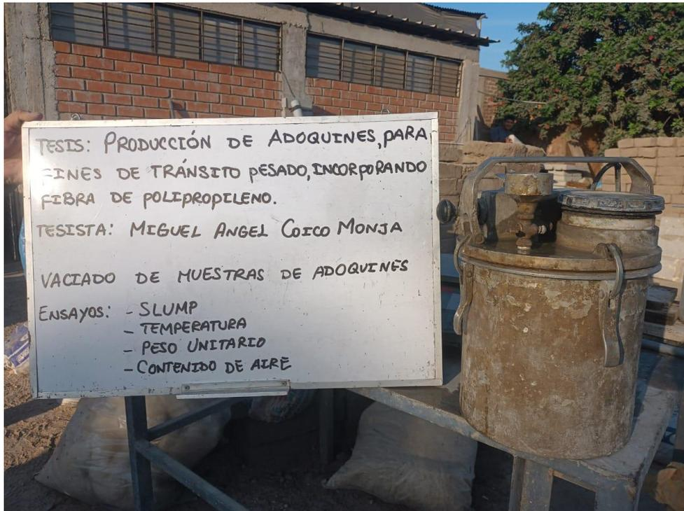
Fotografía 5: Contenido de aire de la mezcla de concreto para adoquines
