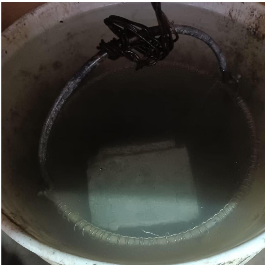
Fotografía 14: Muestra de adoquín sumergida para ensayo de Densidad
