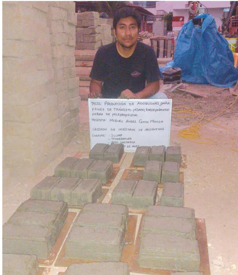
Fotografía 9: Muestras de adoquines con fibra de polipropileno
