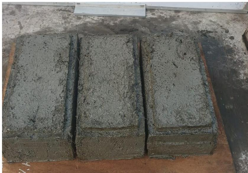
Fotografía 8: Adoquines experimentales con fibra de polipropileno
