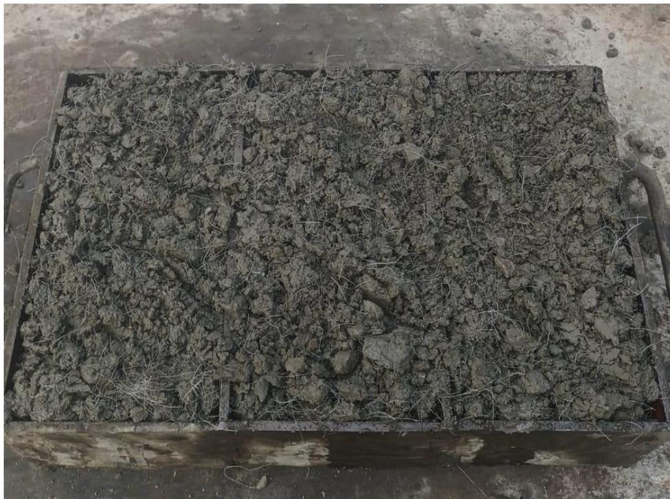
Fotografía 6: Adoquines con fibra de polipropileno
