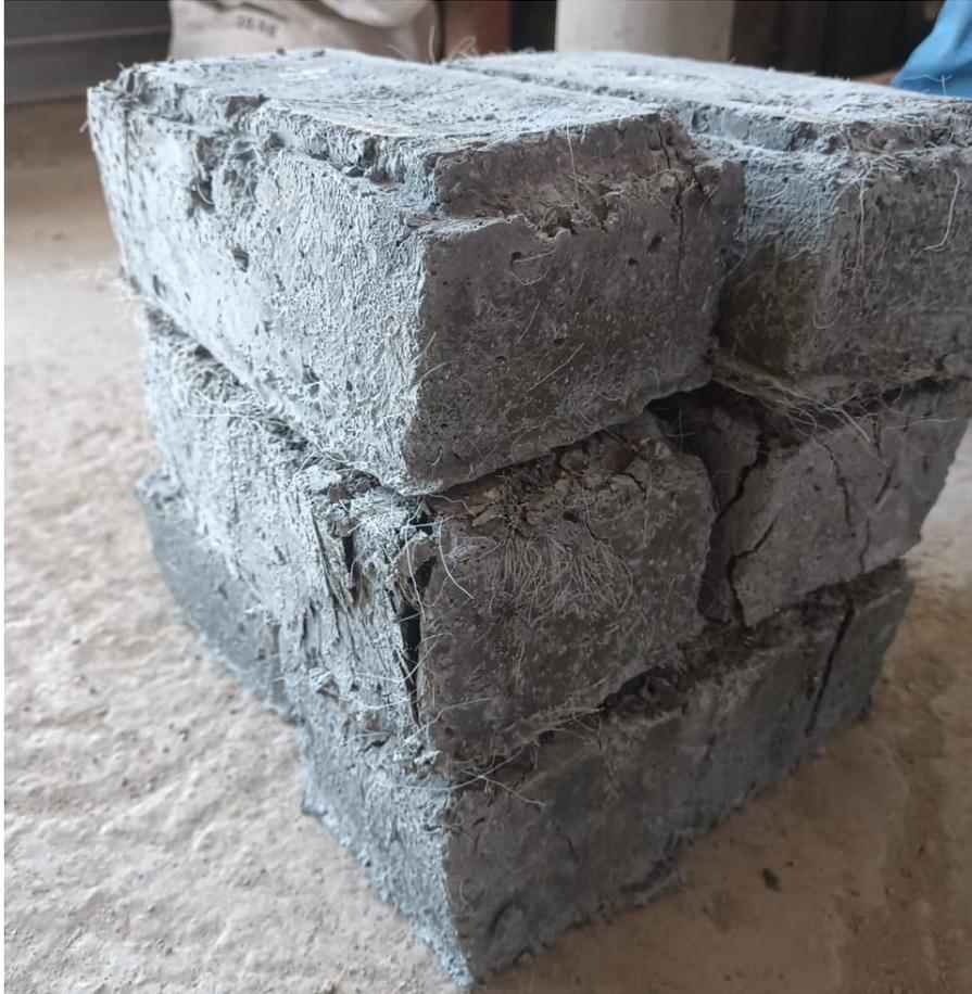
Fotografía 11: Muestras después de resistencia a compresión de adoquines
