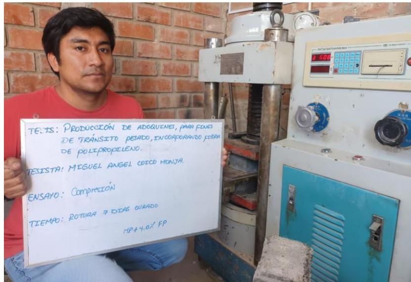
Fotografía 10: Ensayo de resistencia a compresión de adoquines
