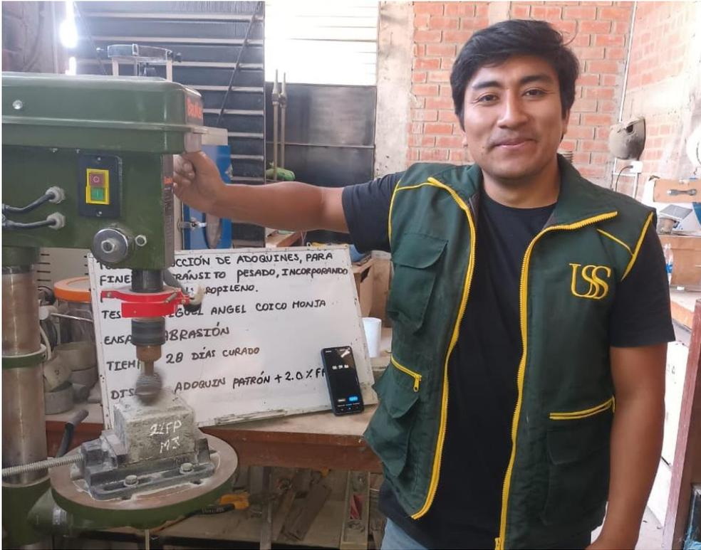
Fotografía 17: Ensayo de Abrasión de adoquín
