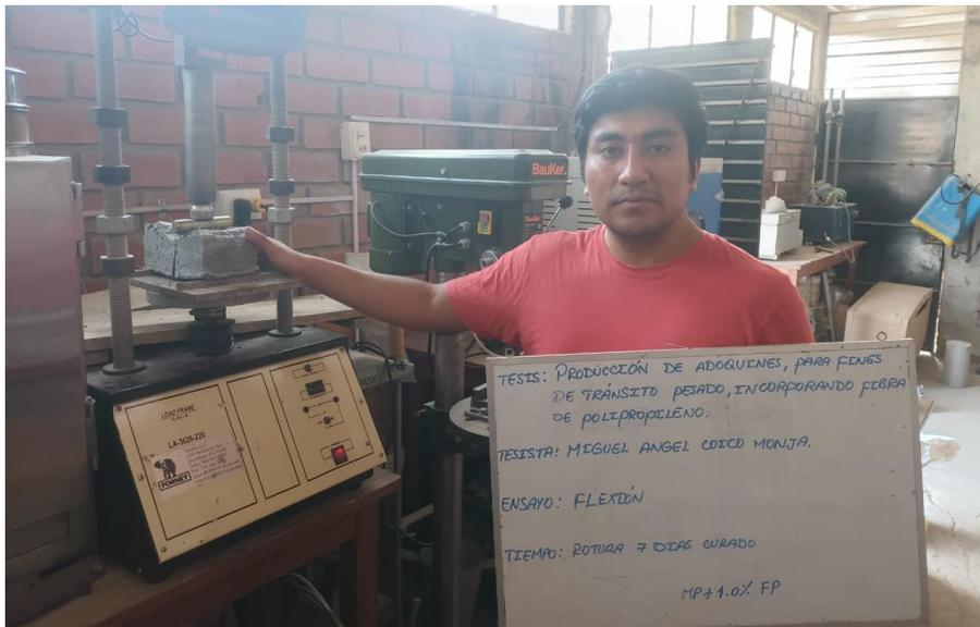
Fotografía 12: Ensayo de resistencia a flexión de adoquines
