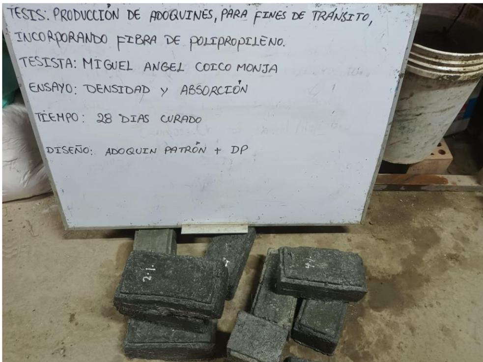
Fotografía 15: Muestras de adoquín para ensayo de Densidad
