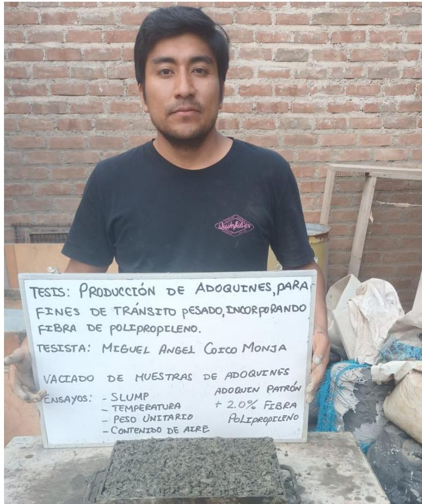
Fotografía 7: Preparación de adoquines con fibra de polipropileno
