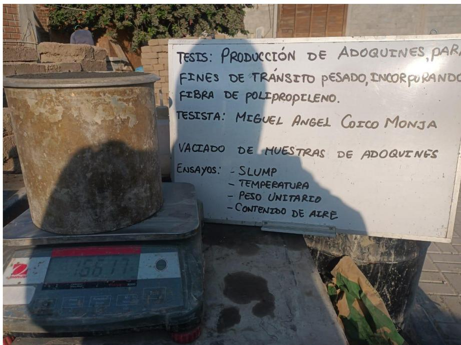
Fotografía 4: Peso Unitario de la mezcla de concreto para adoquines
