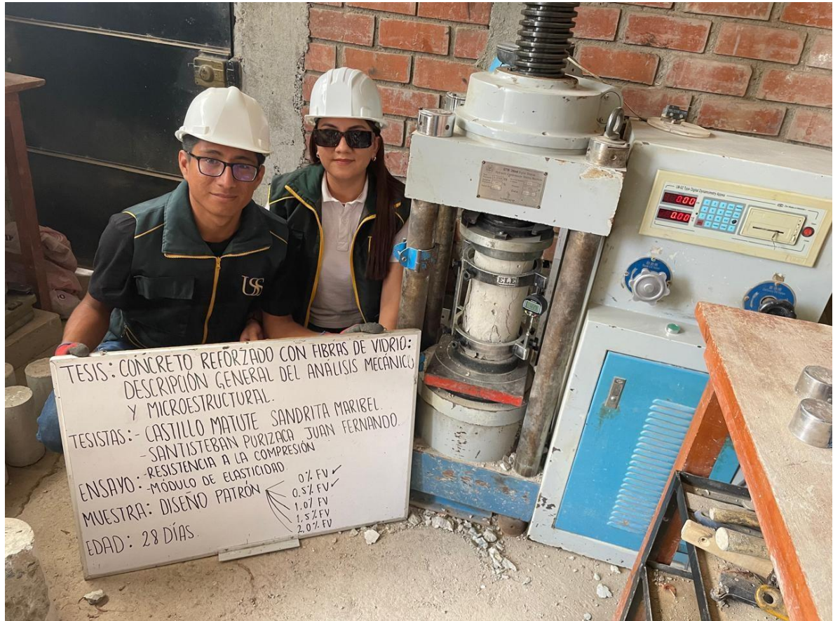
Fig. a1. Ensayos mecánicos a las probetas luego de 28 días de curado (Resistencia a la compresión y módulo de elasticidad).
