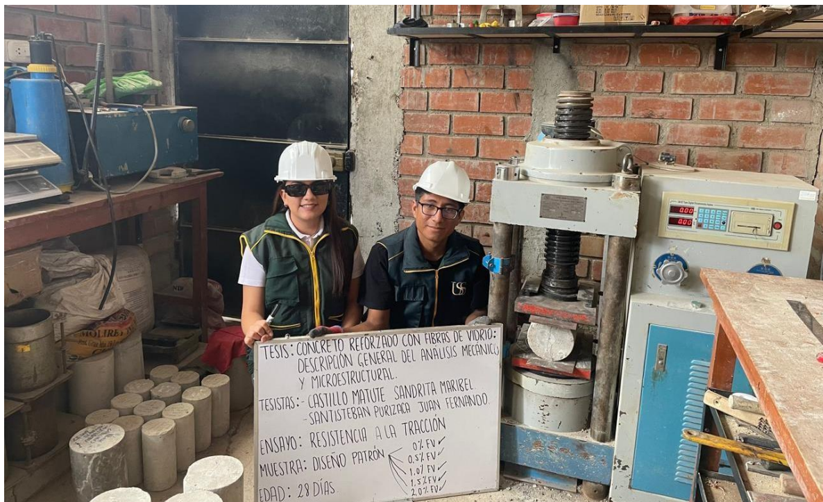
Fig. a1. Ensayos mecánicos a las probetas luego de 28 días de curado (Resistencia a la tracción).
