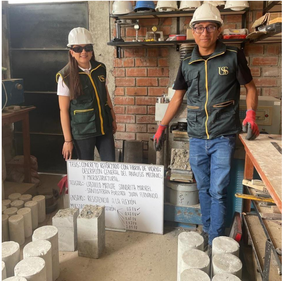
Fig. a1. Ensayos mecánicos a las vigas luego de 28 días de curado (Resistencia a la flexión).
