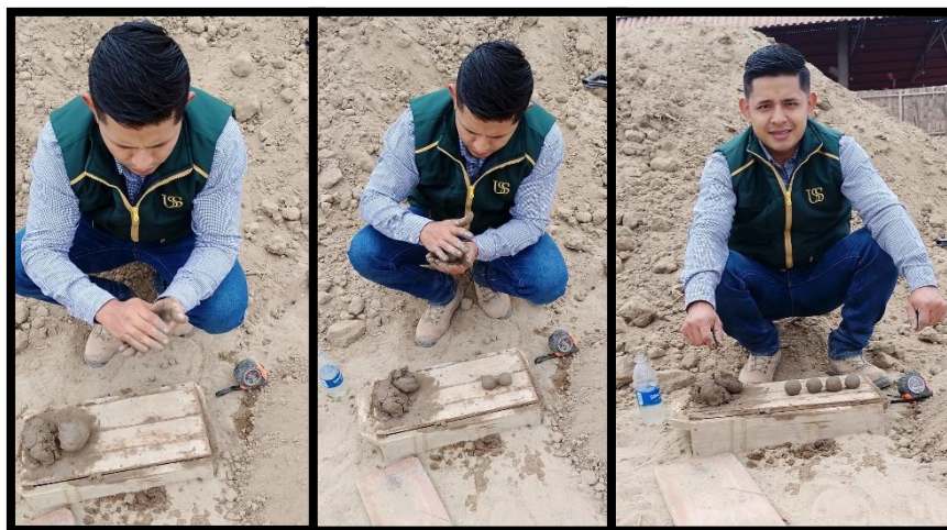
Fig.16. Prueba “Presencia de arcilla o Resistencia seca”.
