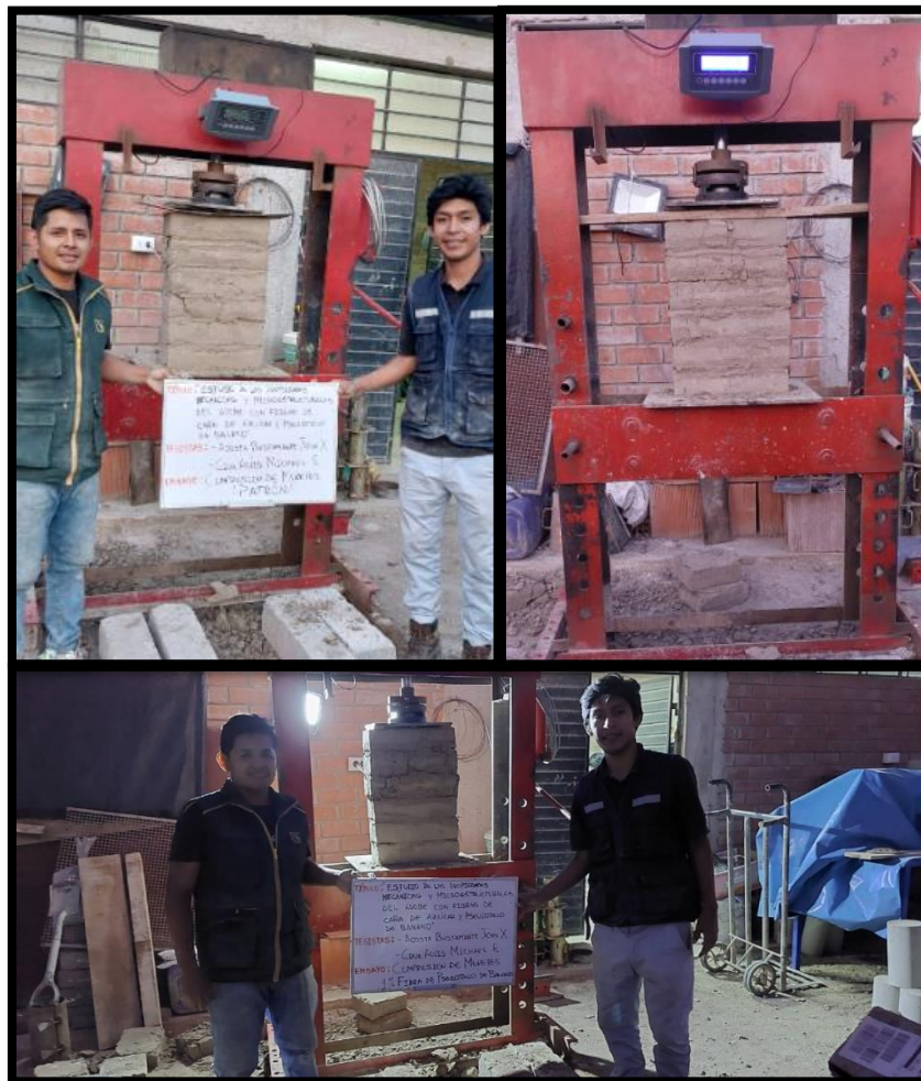
Fig.27. Ensayo compresión de murete.
