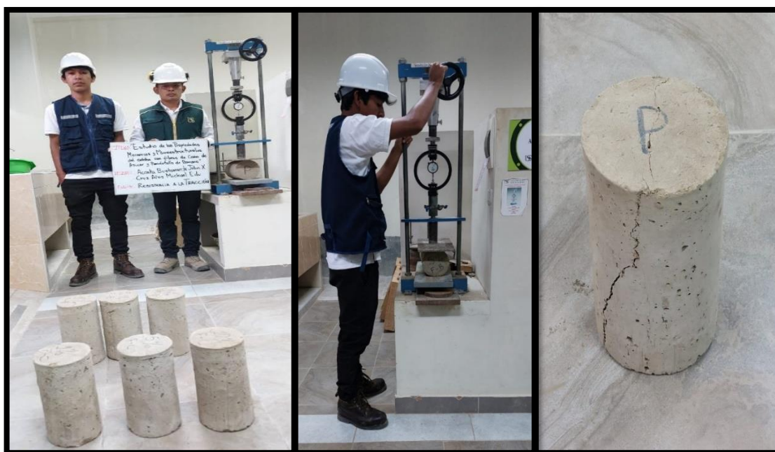
Fig.26. Ensayo a tracción de las probetas de adobe.
