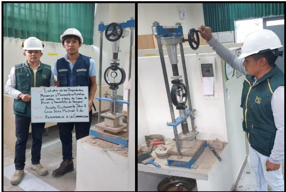
Fig.25. Ensayo de resistencia a compresión.
