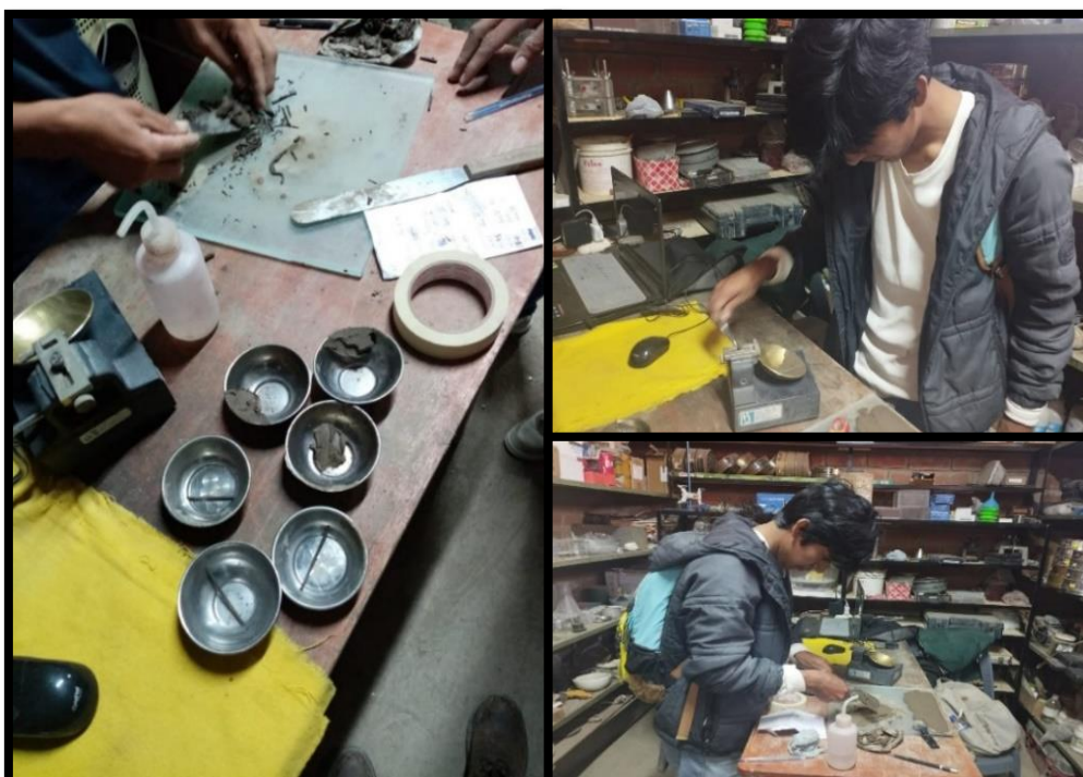
Fig.22. Proceso de realización del ensayo de límites de consistencia o de atterberg.
