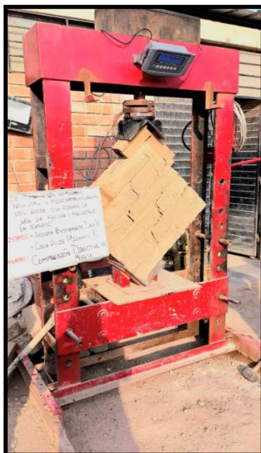
Fig.28. Ensayo de compresión diagonal de muretes.
