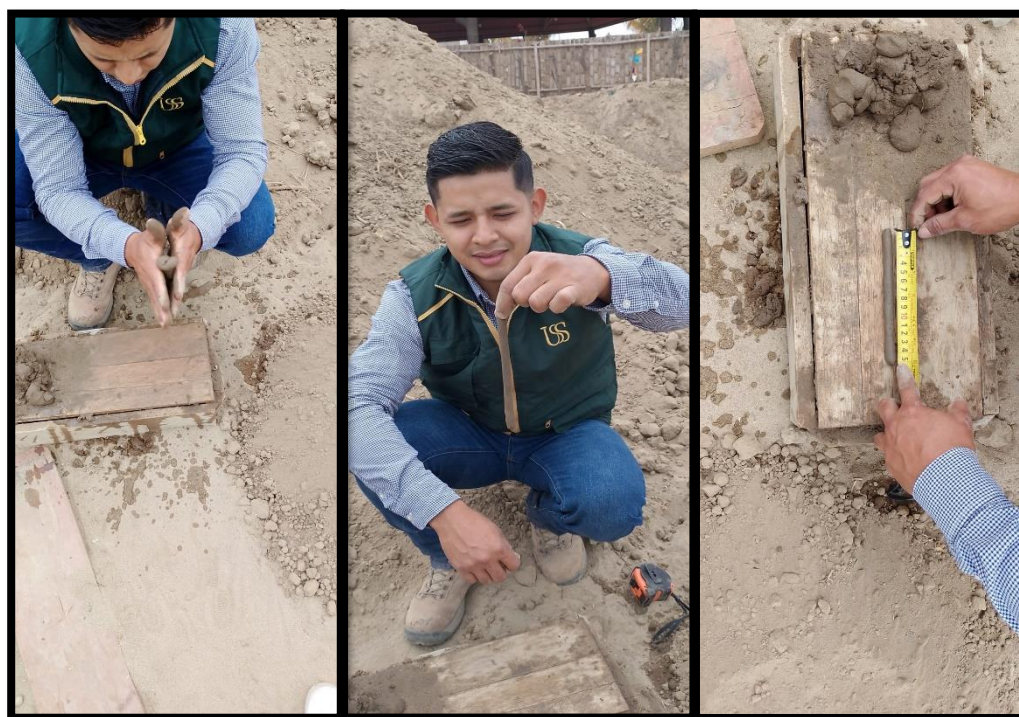
Fig.15. Prueba “Cinta de Barro”.
