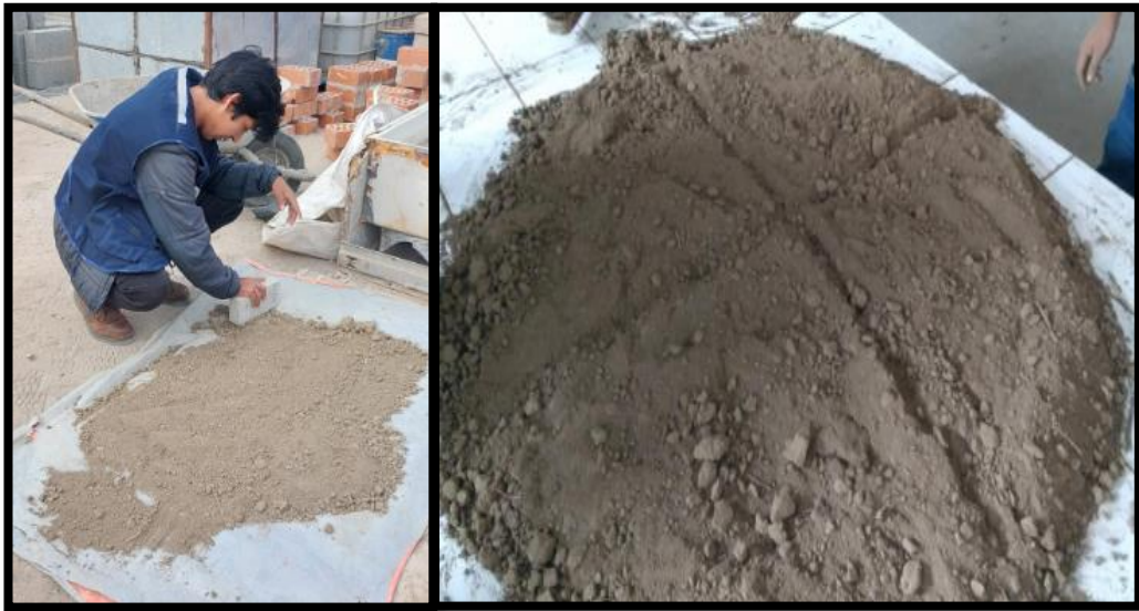
Fig.19. Cuarteo de material antes de realizar los ensayos de laboratorio.
