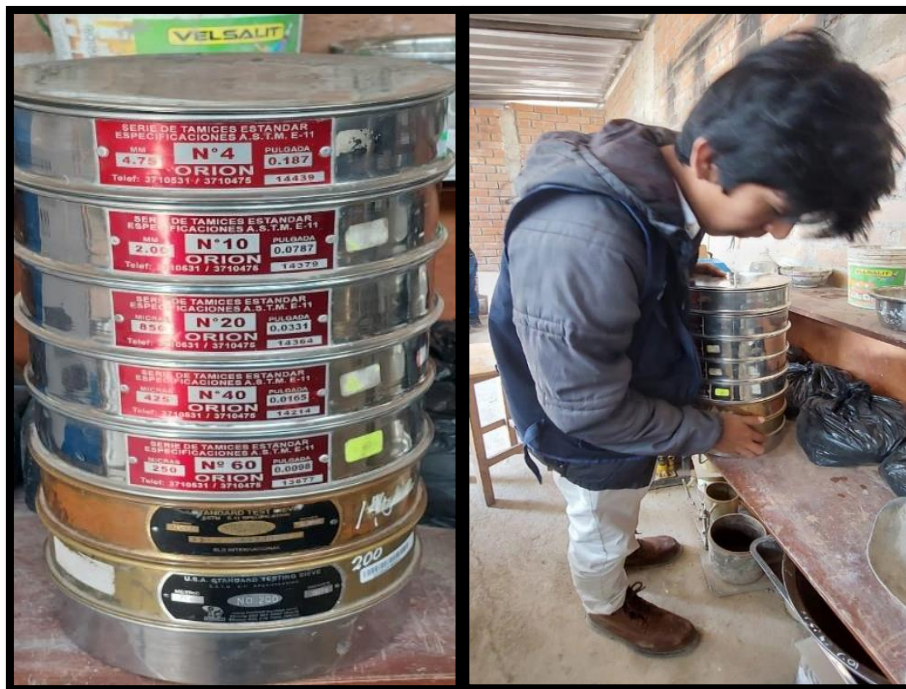
Fig.20. Ensayo de análisis granulométrico – Tamices estandarizados.
