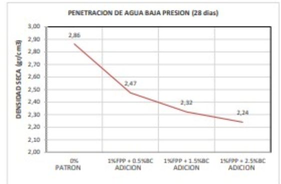
EN ESTA GRAFICA DE NUESTRA LA PENETRACION DE AGUA BAJO PRESION "DURABILIDAD"
