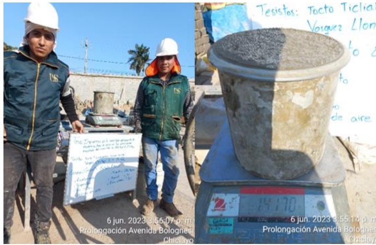
Fig.24. Ensayo del Peso Unitario del concreto recién elaborado
