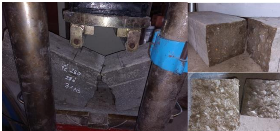
Fotografía 15: Muestras fracturadas de concreto después de someter a ensayos de resistencia mecánica
