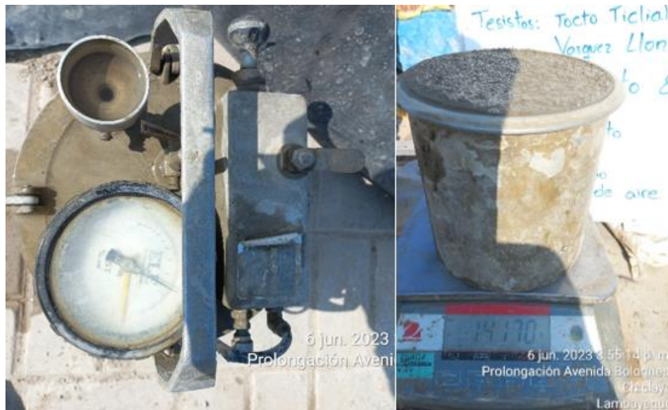
Fotografía 11: Ensayo del contenido de humedad y peso unitario
