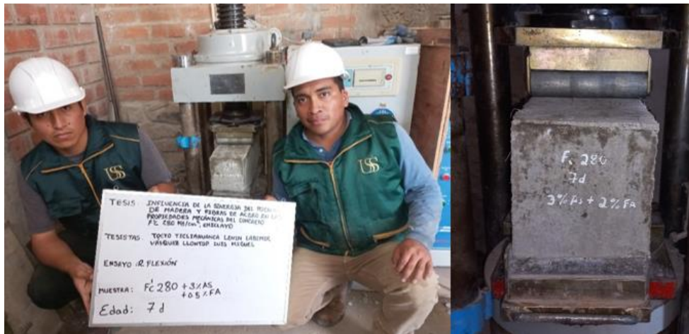
Fotografía 14: Ensayo de la resistencia a la flexión
