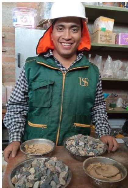
Fig.19. Muestras de los agregados después de 24h en el horno
