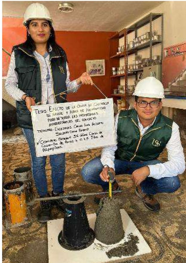
Fig. 26. Prueba de Slump Combinación CCA+FP
