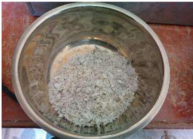
**Fig. 3.** Fibra de Polipropileno
