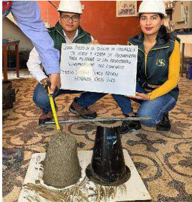
Fig. 25. Prueba de Slump Concreto Patrón
