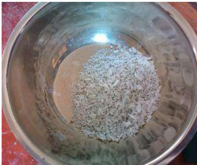
**Fig. 17.** Fibra de Polipropileno (FPP)
