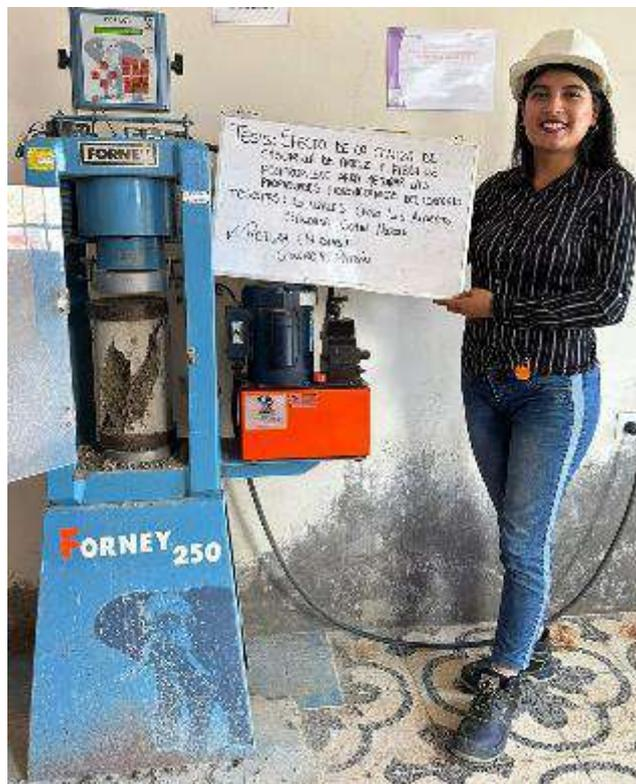
**Fig. 24.** Rotura Concreto Patrón
