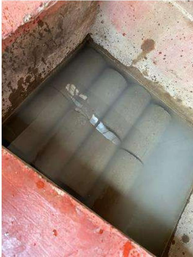
**Fig. 27.** Curado de Muestras de Concreto
