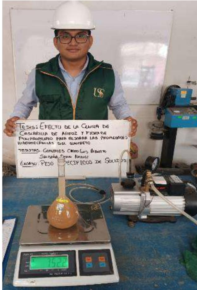
**Fig. 21.** Ensayo Peso Específico de Sólidos
