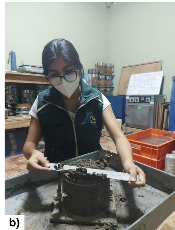
Fig 14. Ensayo de Proctor Modificado. a) Compactado del suelo. b) Enrasado de material.
