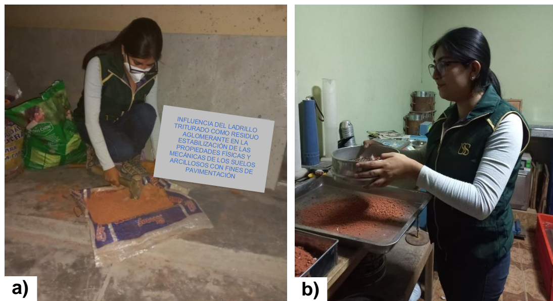
Fig 12. Residuos de ladrillo. a) Ladrillo triturado b) Tamizado de ladrillo triturado
