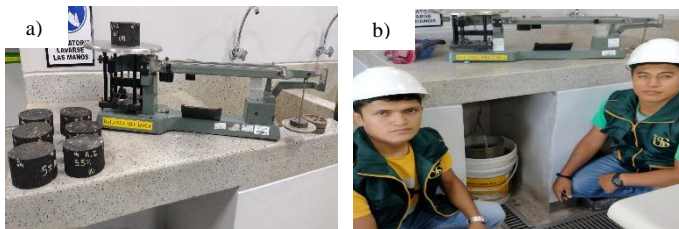
Fig. 8. (a, b) Peso específico bulk de muestras compactadas
