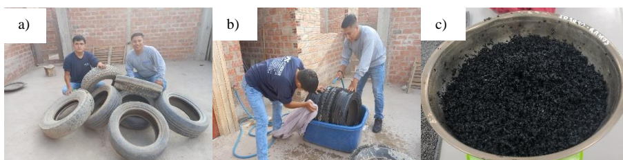
Fig. 1. (a) Recolección de neumáticos, (b) Lavado y desinfección, (c) Granulado
