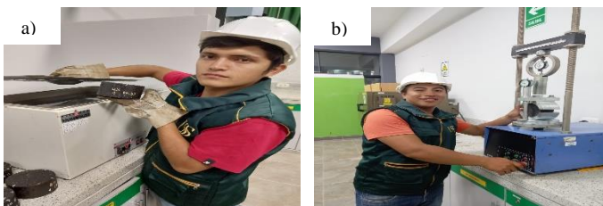
Fig. 10. (a) Baño maría (b) Estabilidad y flujo (marshall)
