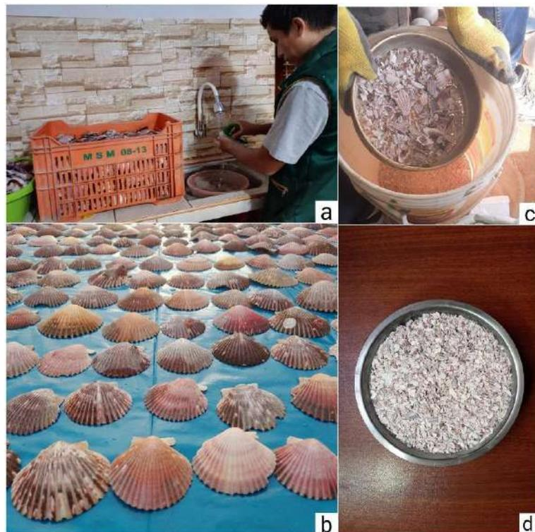
**Fig. 12.** Tratamiento Argopecten, (a)Lavado, (b)Secado, (c)Tamizado, (d)Argopecten
