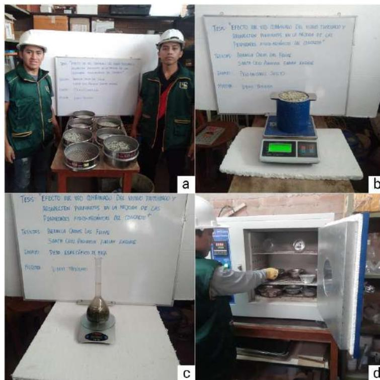
**Fig. 14.** Propiedades físicas Vidrio, (a)Granulometría, (b)Peso unit., (c)Peso específico, (d) Cont. humedad
