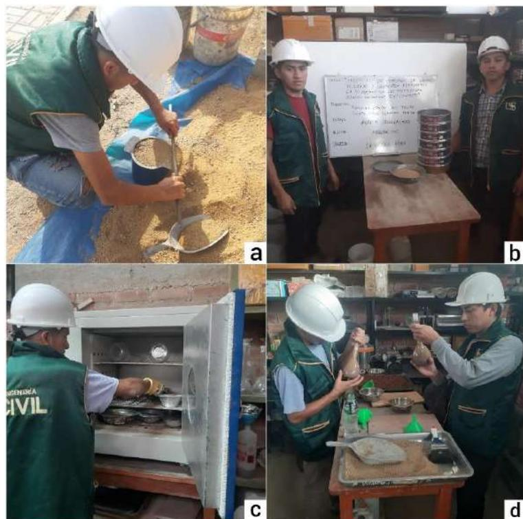
**Fig. 10.** Agregados, (a)Peso unitario, (b)Granulometría, (c) Peso específico., (d)Cont. Humedad
