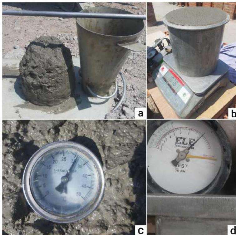
**Fig. 18.** Ensayos físicos, (a) Slump, (b) Peso unitario, (c) Temp., (d) Cont. aire
