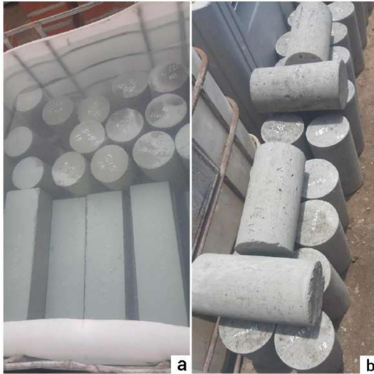
**Fig. 17.** (a) Curado, (b) Muestras para ensayos
