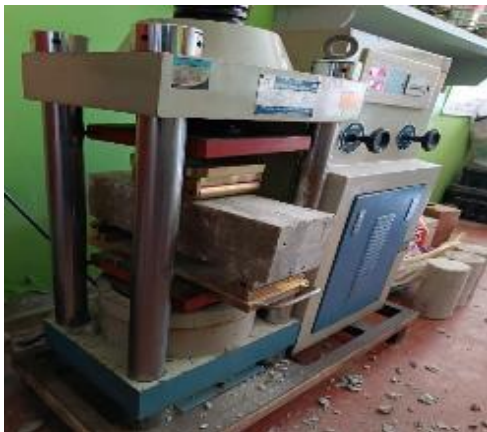
Fotografía 09: Ensayo resistencia a flexión.
