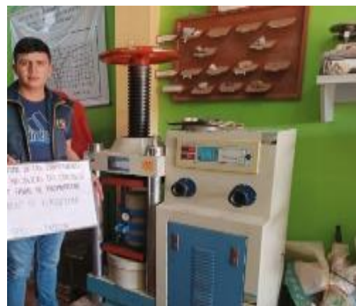
Fotografía 10: Ensayo Módulo elasticidad
