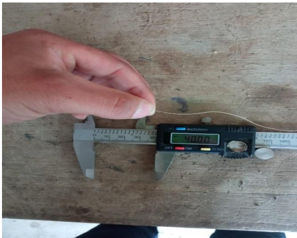
Fotografía 02: Longitud de Fibra de Cabuya
