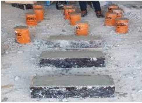
Fotografía 05: Vaciado de probetas y vigas
