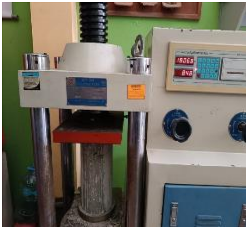
Fotografía 07: Ensayo resistencia a compresión.
