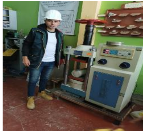
Fotografía 08: Ensayo resistencia a tracción.
