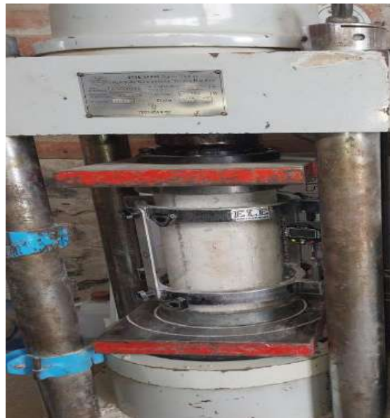
Fig. 13. Ensayo Resistencia a la Compresión.
