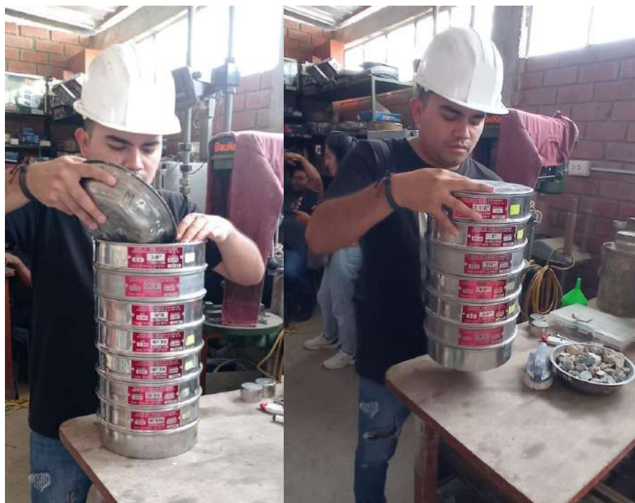
Fig. 40 Ensayo de granulometría de agregado fino y grueso.
