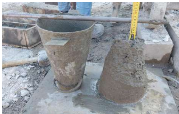
Fig. 10. Asentamiento del Concreto.
