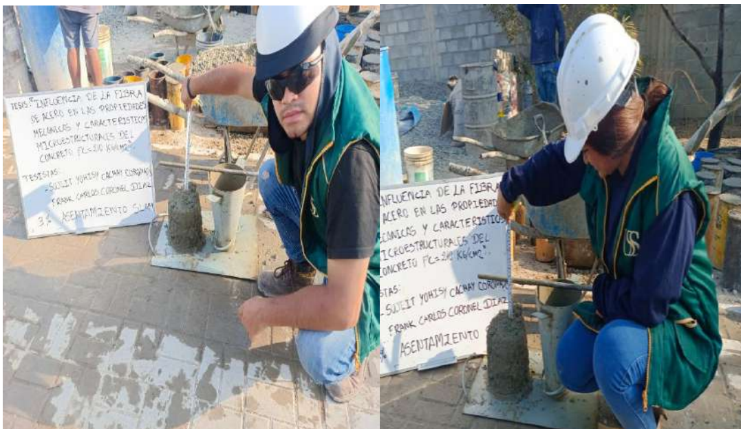
Fig. 49 Ensayo de consistencia del concreto en su estado fresco
