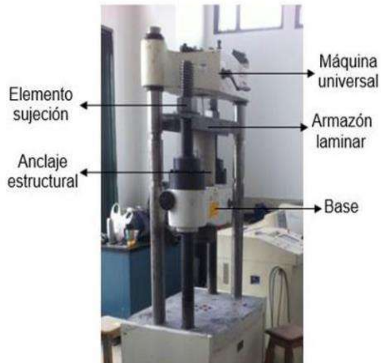
Fig. 5. Montaje de máquina para ensayo de tracción [54]
