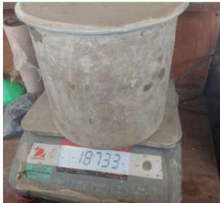
Fig. 12. Ensayo de Peso Unitario.
