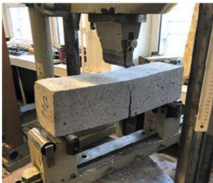
Fig. 4. Prueba de flexión de tres puntos. [41]
