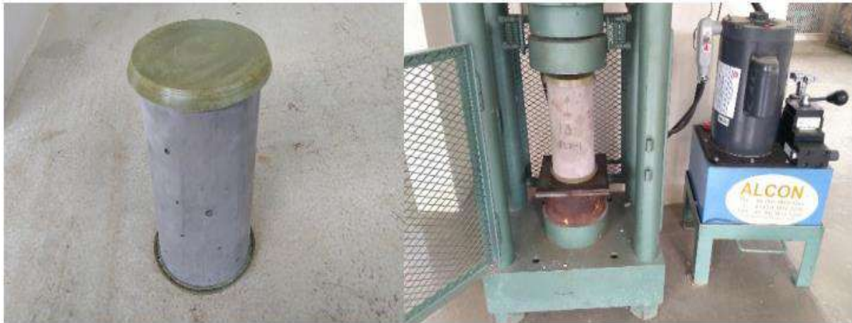
Fig. 3. Prueba de resistencia a la compresión. [51]
