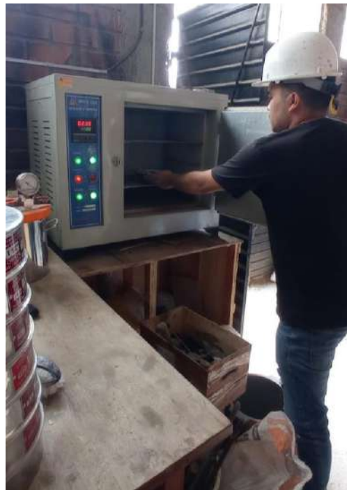
Fig. 43 Ensayo de contenido de humedad del agregado fino y grueso.
