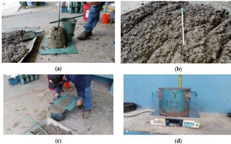
Fig. 2. Pruebas de (a) asentamiento, (b) temperatura, (c, d) peso unitario. [51]
