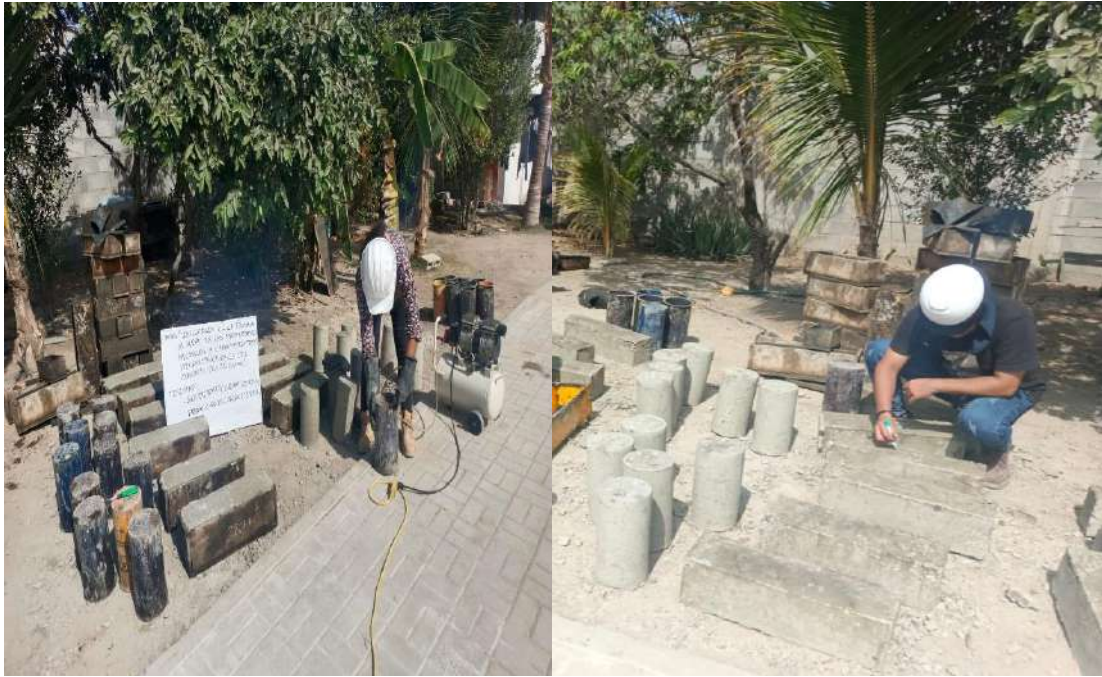
Fig. 54 Desmoldado y marcación de los cilindros y vigas de concreto.
