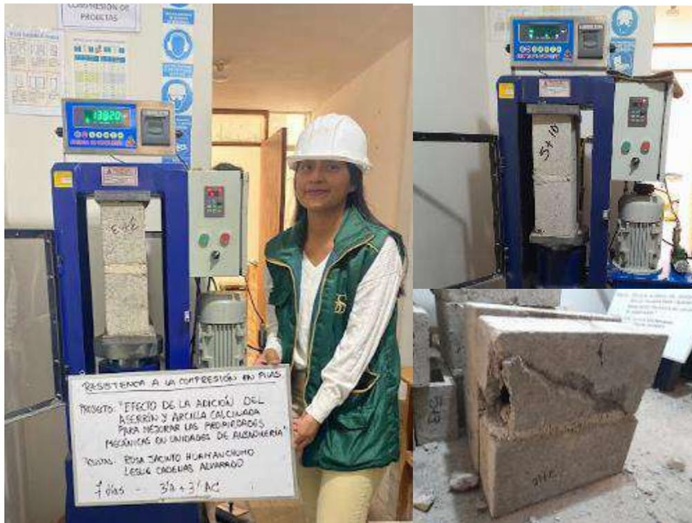
Resistencia a compresión en pilas de 2 und
