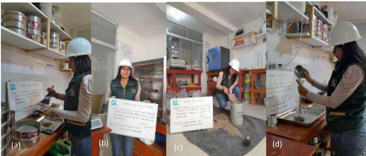
Ensayos físicos a la arcilla calcinada (a) Granulometría, (b) Contenido de humedad, (c) Peso unitario, (d) Peso específico y absorción
