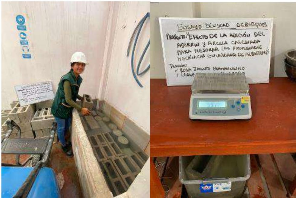
Ensayo de densidad y absorción en bloques de concreto
