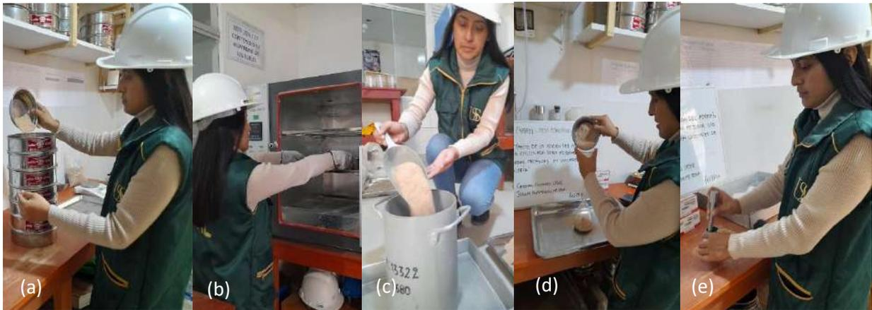
Ensayos físicos al aserrín (a) Granulometría, (b) Contenido de humedad, (c) Peso unitario, (d) Peso específico y (e) Absorción
