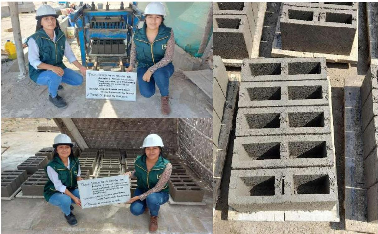
Proceso de fabricación de bloques de concreto
