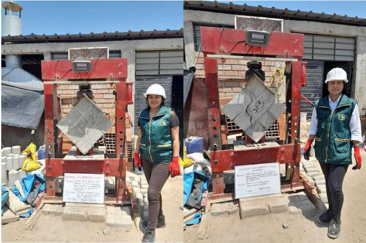
Resistencia a compresión en muretes de 0.60m x 0.60m
