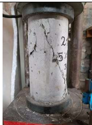
17)Falla de probeta de concreto por compresión
