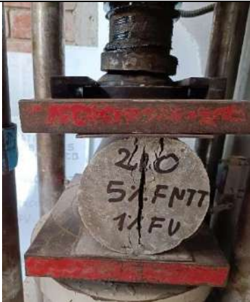
22) Falla por tracción en el concreto
