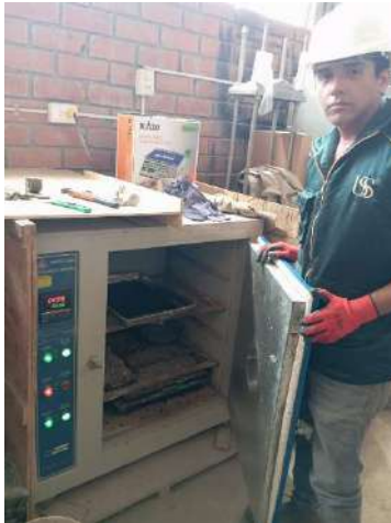
7) Tratamiento térmico del caucho
