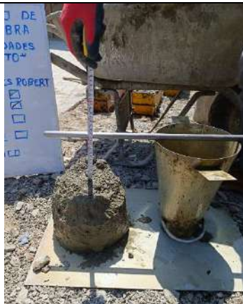
10) Ensayo de slump del concreto fresco
