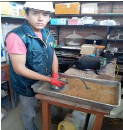
4) Ensayo de peso específico de la arena
