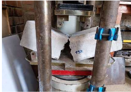
20) Falla en vigas de concreto
