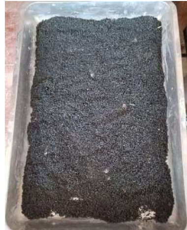
8) Caucho granulado térmicamente tratado
