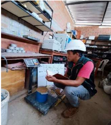
1) Ensayo de peso unitario a los agregados
