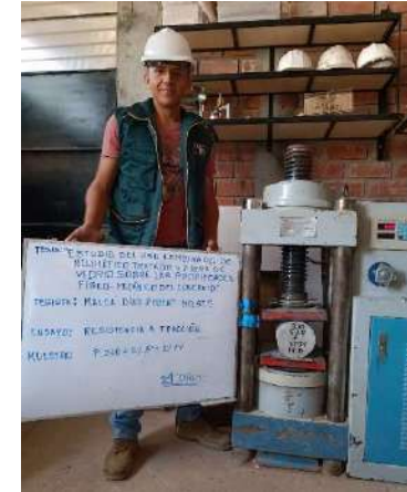
21) Ensayo de tracción del concreto
