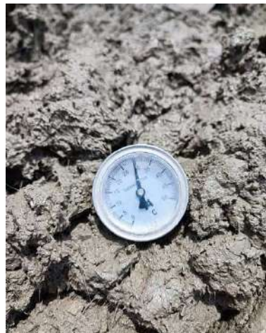
14) Ensayo de temperatura de mezclado
