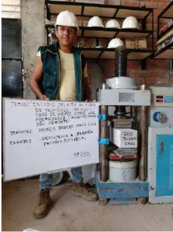
19) Ensayo de flexión en vigas de concreto
