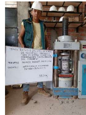
15) Ensayo de compresión del concreto
