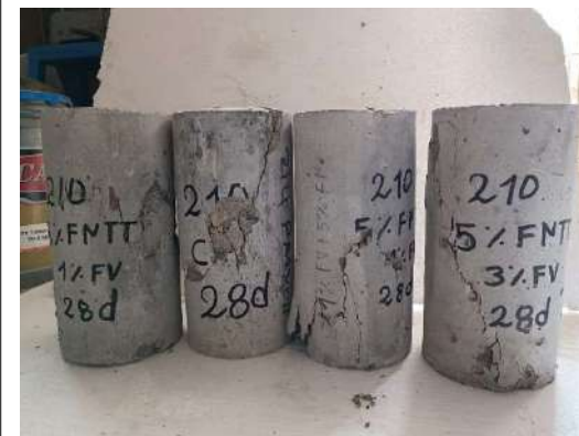
18)Probetas luego del ensayo de compresión
