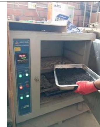
6) Tratamiento térmico del caucho
