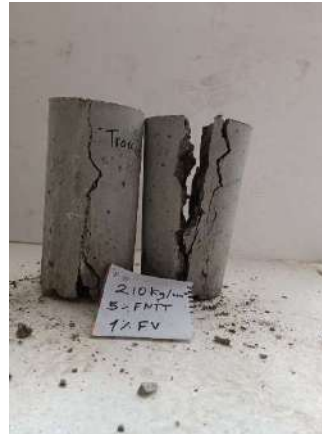
23) Falla por tracción en el concreto
