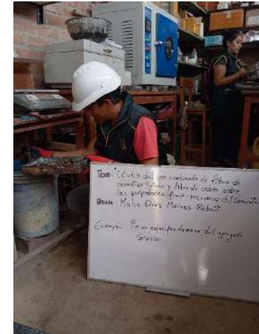
3) Ensayo de peso específico de grava
