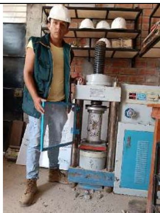
16) Ensayo de compresión del concreto
