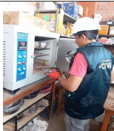
5) Ensayo de contenido de humedad de agregados
