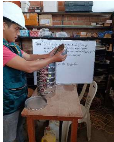
2) Ensayo de granulometría de agregados
