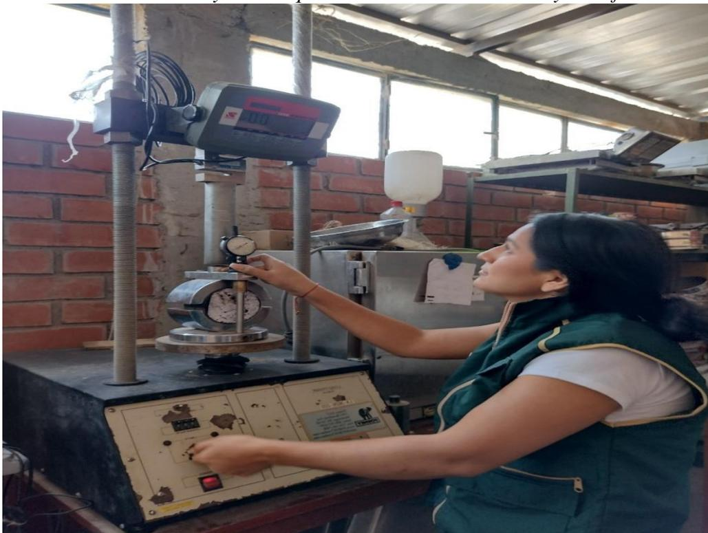
*Ilustración 14. Ensayo estabilidad y flujo de briquetas de MAC – 2 Estándar y modificada*
