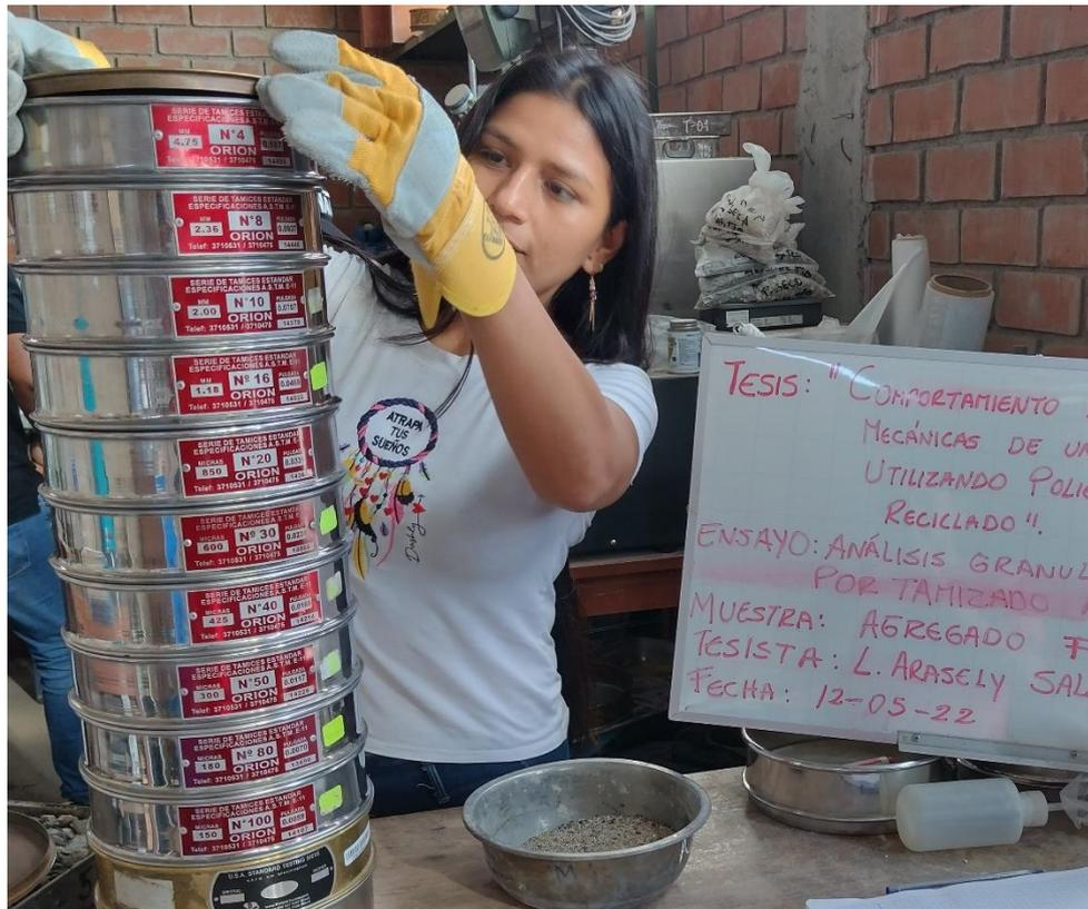
*Ilustración 7. Análisis granulométrico del agregado fino*
