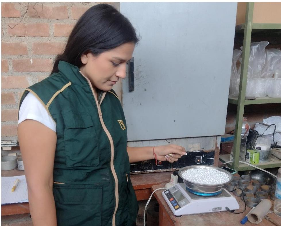
*Ilustración 8. Muestra de poliestireno para ensayo granulométrico*
