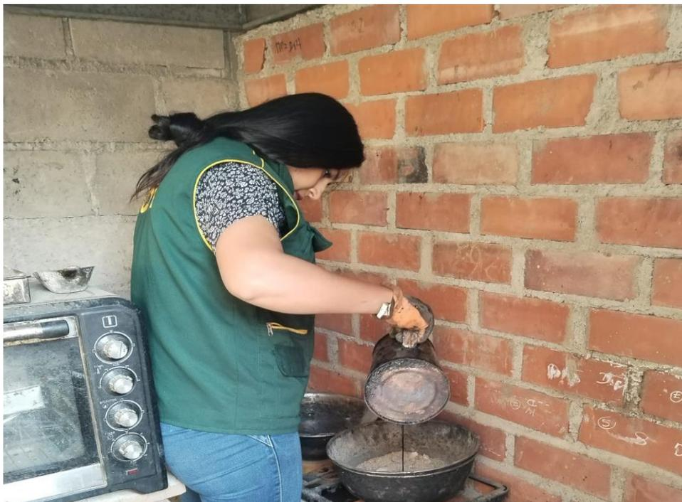
*Ilustración 10. Elaboración de briquetas mediante método Marshall*
