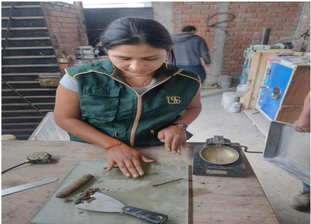
*Ilustración 4. Ensayo de límites de Atterberg- agregado fino*
