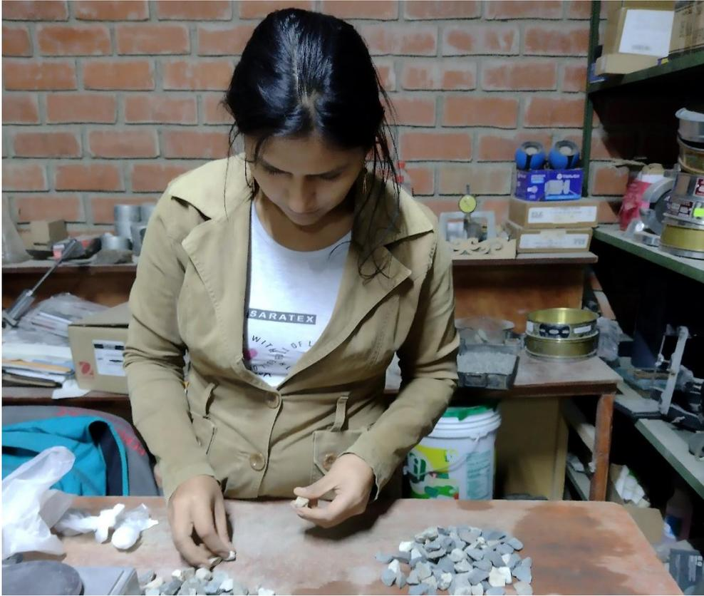
*Ilustración 5. Ensayo físico del agregado grueso – Caras fracturadas*
