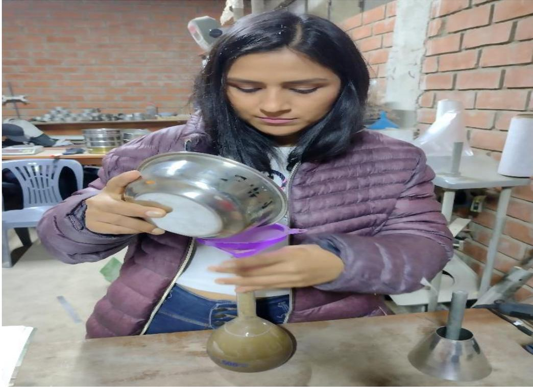
*Ilustración 3. Ensayo de peso específico del agregado fino*
