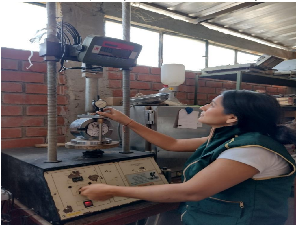
Ilustración 13. Ensayo de briquetas de MAC – 2 Estándar y modificada
