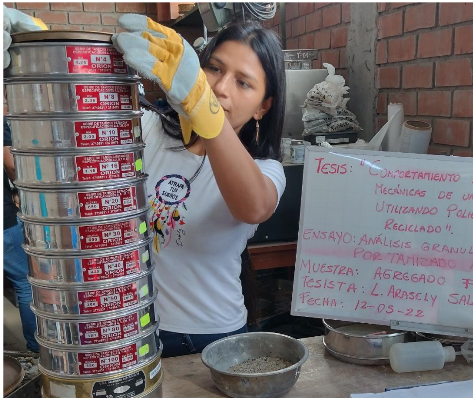
Ilustración 7. Análisis granulométrico del agregado fino
