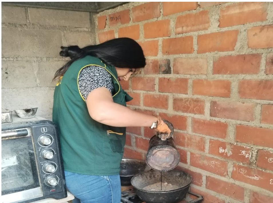
Ilustración 10. Elaboración de briquetas mediante método Marshall
