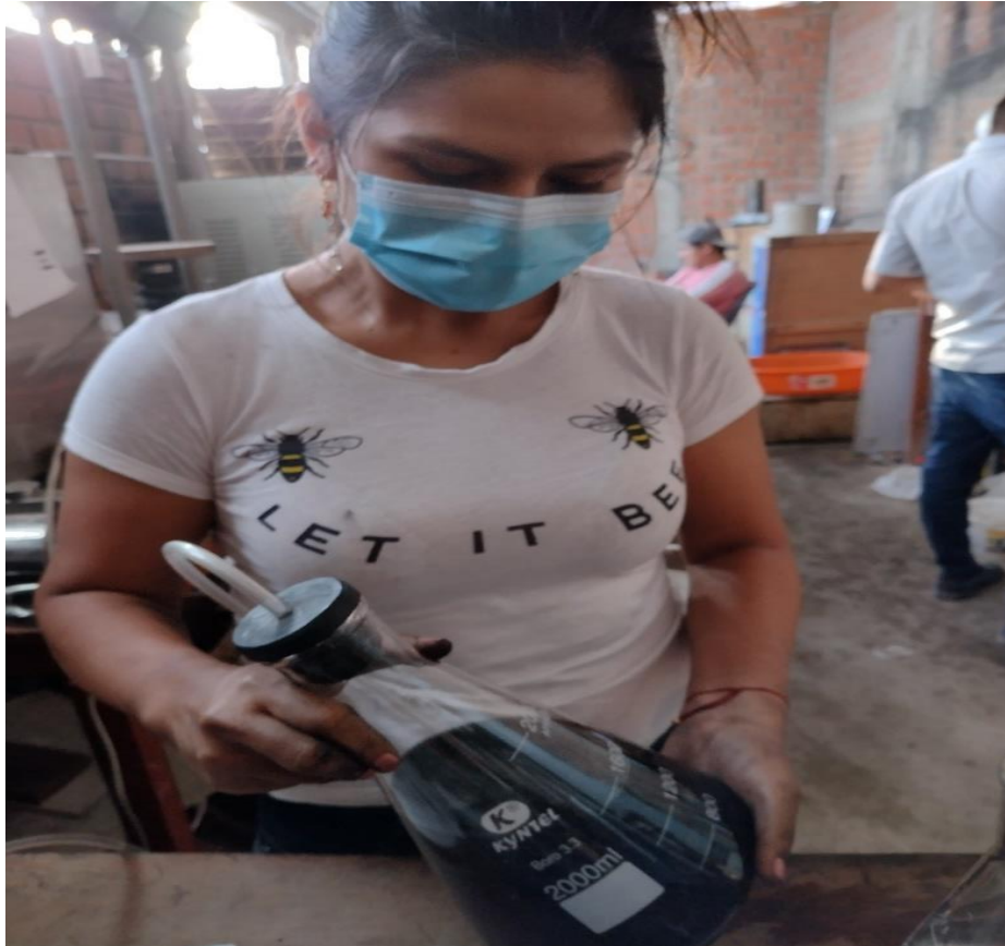
Ilustración 9. Ensayo Rice de la MAC – 2
