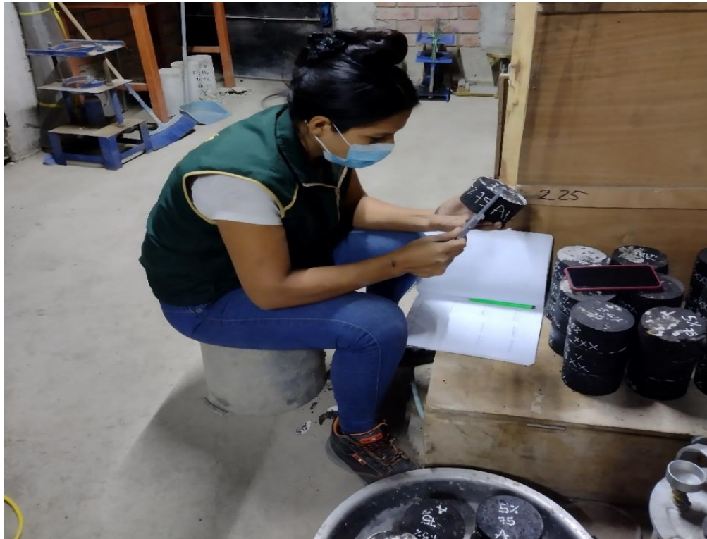
Ilustración 11. Dimensiones de briquetas de MAC – 2 estándar y modificadas con EPS
