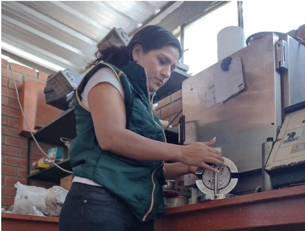
Ilustración 13. Ensayo de briquetas de MAC – 2 Estándar y modificada
