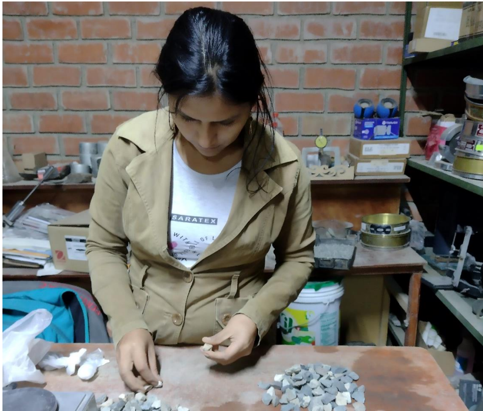
Ilustración 5. Ensayo físico del agregado grueso – Caras fracturadas
