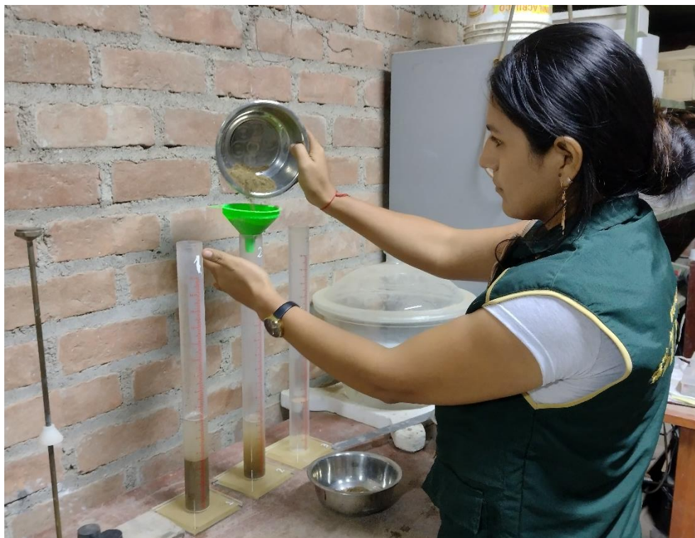
Ilustración 6. Ensayo físico del agregado fino – Equivalente de arena
