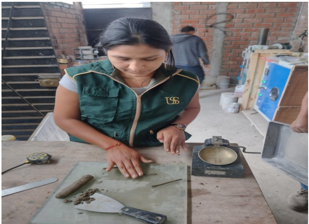
Ilustración 3. Ensayo de peso específico del agregado fino
