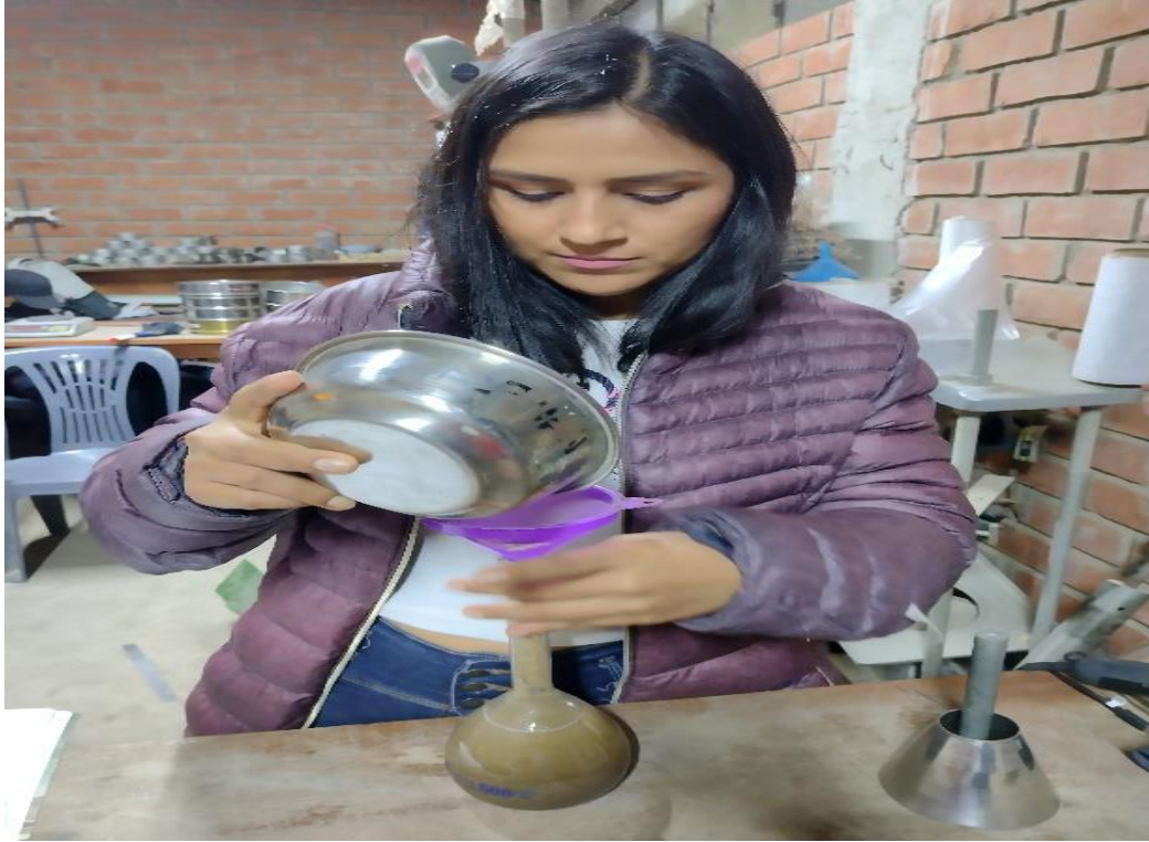
Ilustración 3. Ensayo de peso específico del agregado fino
