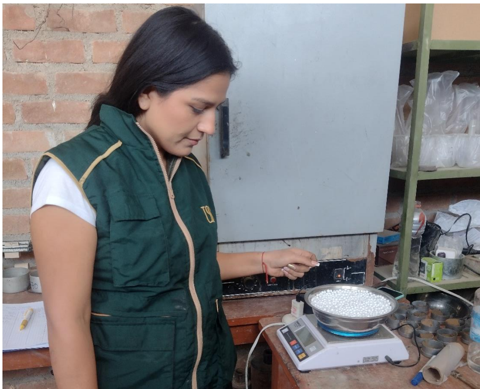
Ilustración 8. Muestra de poliestireno para ensayo granulométrico
